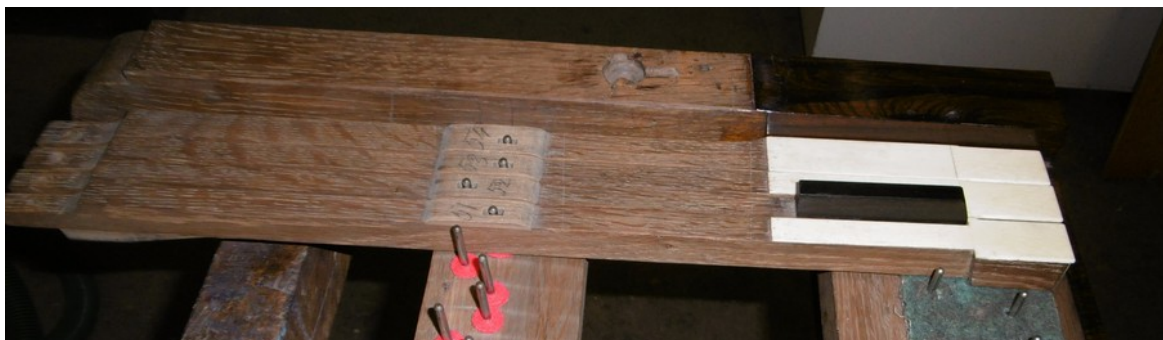
Les placages d'ivoire sont nettoyés , ponçés et blanchis avant d'être repolis
