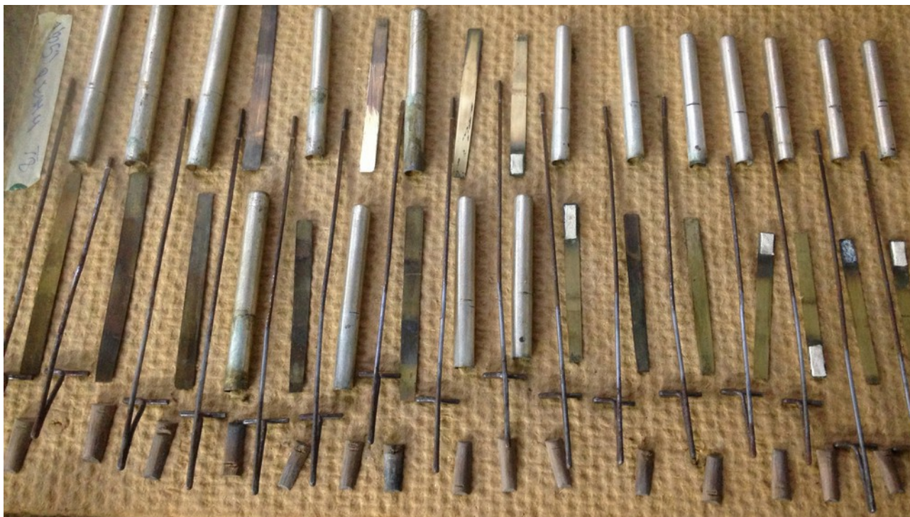
Les éléments des tuyaux de trompette pendant la restauration
