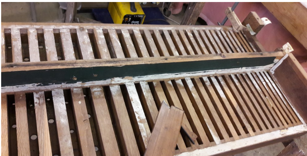
Les barrages sont rabotés avant d'être à nouveau recouverts d'un parchemin neuf
