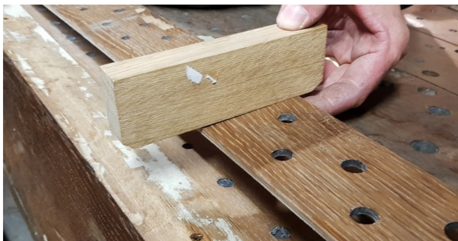
Les registres très souvent tuilés, ont été redressés ou même remplacés si nécessaire
