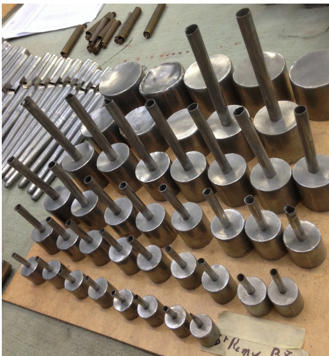
Les calottes du Bourdon 8 avant le redressage des cheminées et le débosselage des calottes
