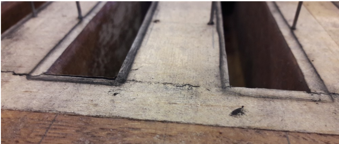
Après dépose des soupapes, les fentes apparaissent dans le parchemin
