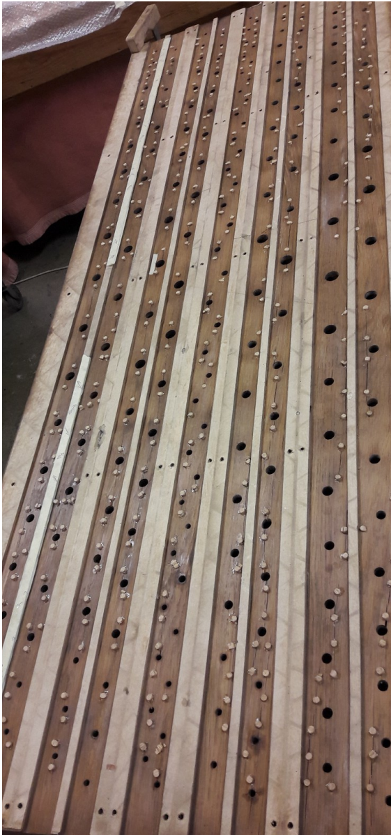
Les très nombreuses fentes des tables ont été refermées par des petits bouchons de chêne
