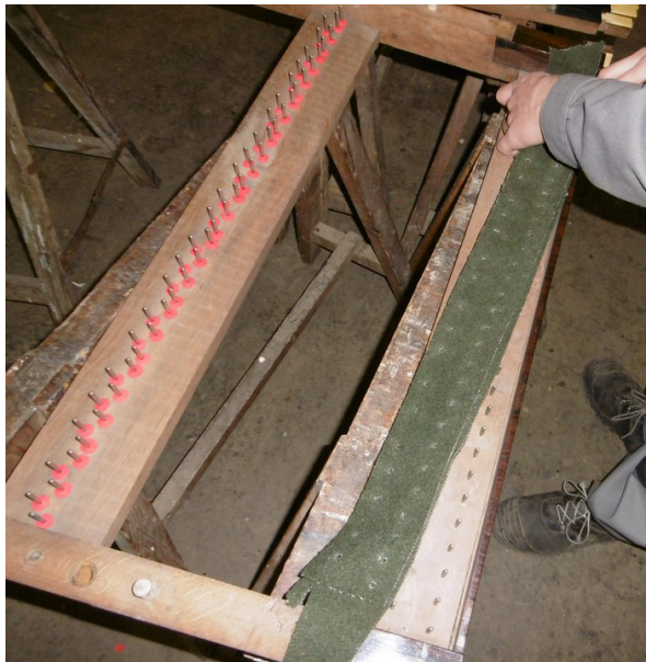
Les mouches et les garnitures de laine tissée sont remplacées
