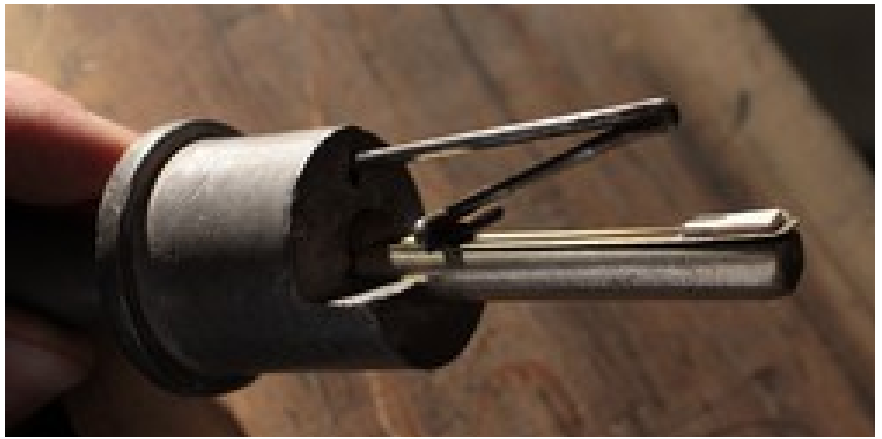
Les languettes des basses de trompette portent un morceau de peau pour assourdir le son
