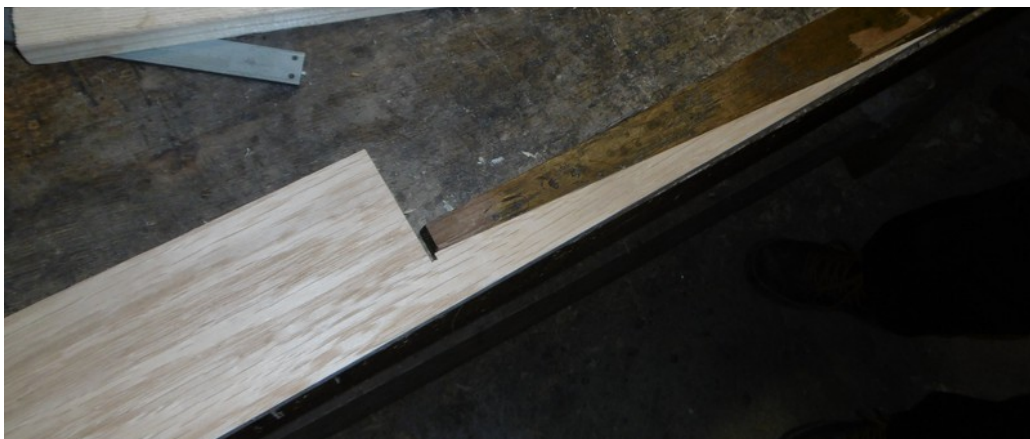
Greffe neuve sur l'abattant du couvercle de console, avant mise en teinte
