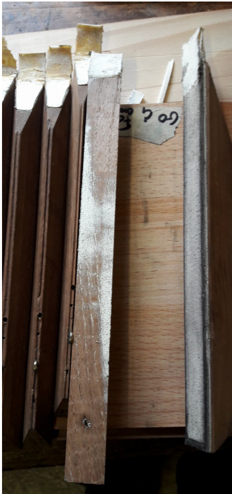
Les soupapes qui ne sont pas étanches sont débarrassées de leur peau et redressées avant de recevoir une nouvelle peau épaisse et calibrée
