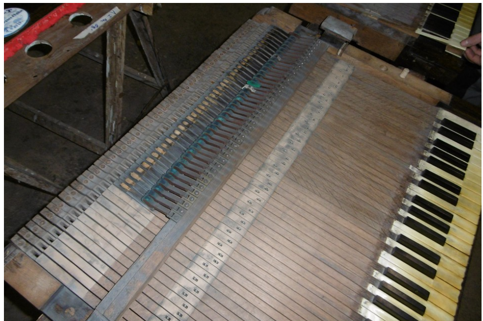
Restauration du clavier de G.O. et son système d'accouplement par masselottes
