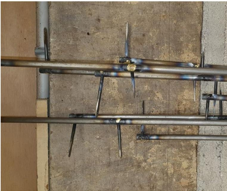
Ci-dessus : rouleaux d'abrégé en cours de fabrication dans notre atelier, à l'ancienne à partir de barres de fer brutes et forgées par nos soins.
