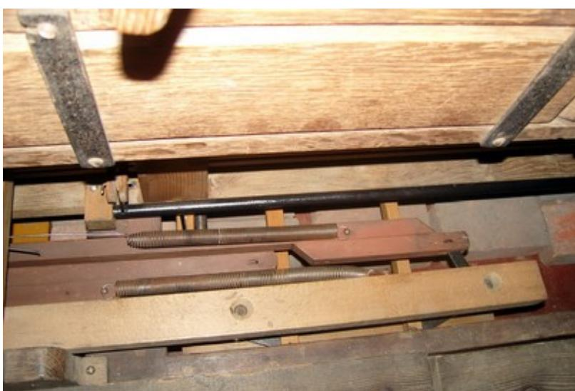
Les ressorts de rappel des cuillères peuvent être à l'intérieur de l'instrument, placés horizontalement
