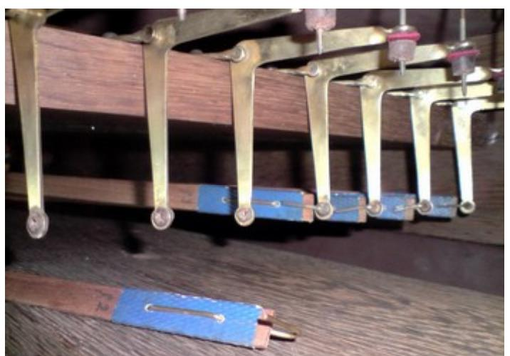
Les équerres sous les layes sont suspendues aux soupapes avec un léger « armement » pour le confort du toucher
