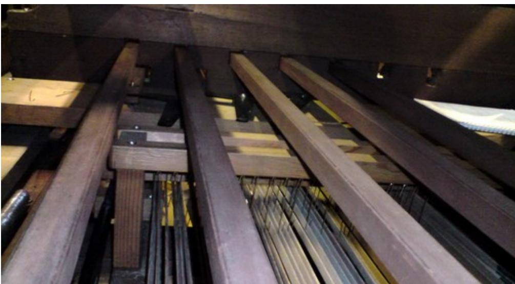
Les arrières des touches des deux claviers en place, les masselottes d'accouplement et les bras d'abrégés du clavier de G.O.
