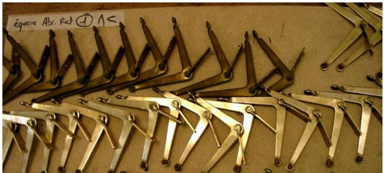
Crapaudines de laiton avant et après nettoyage et remplacement des cuirs (paliers des axes)
