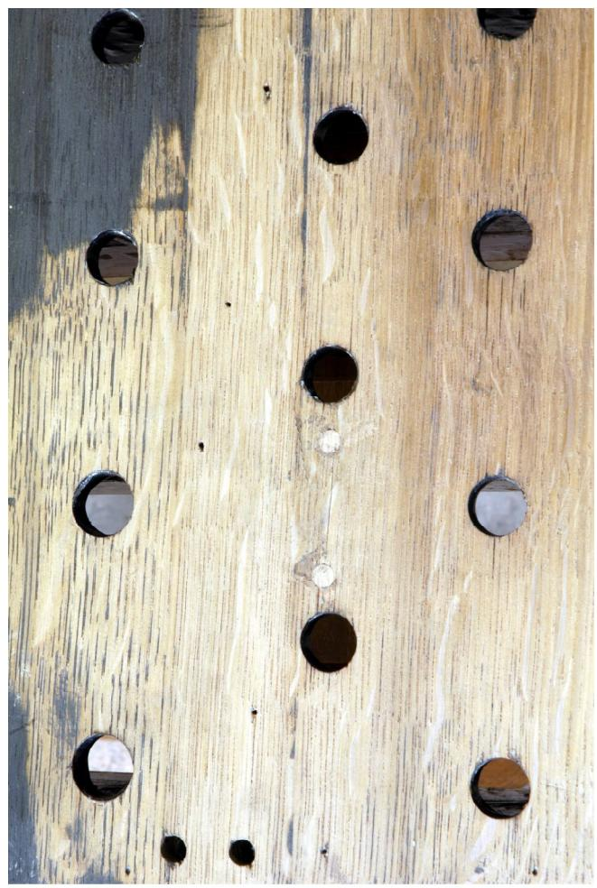
Après l'encollage des gravures, les tables ont été redressées à la varloppé et les fentes fermées par des bouchons de chêne. Puis l'ensemble a été regraphité avant la mise en place des registres
