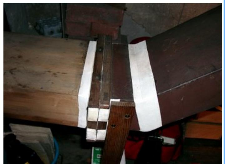
Porte vent d'alimentation d'un moteur auxilliaire pour les basses du G.O.. Trappe d'accès à une soupape coupe-vent, bloquée ouverte.
