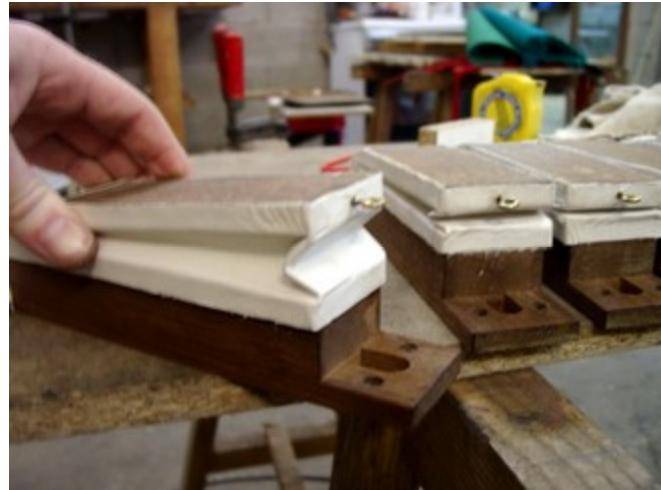
Après le remplacement des peaux et avant le remontage de tous les éléments qui composent ces moteurs auxilliaires
