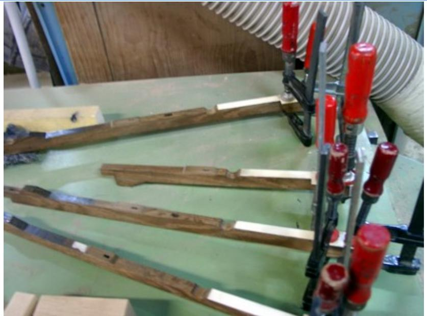
Les masselottes avant le remplacement du feutre vert et les touches des claviers en cours de replacage
