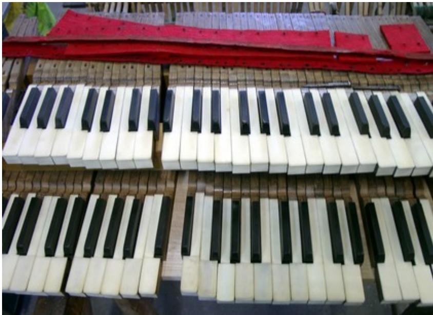
Les deux claviers en atelier. Les feutres et casimirs d'origine ont été remplacés quand c'était nécessaire.
