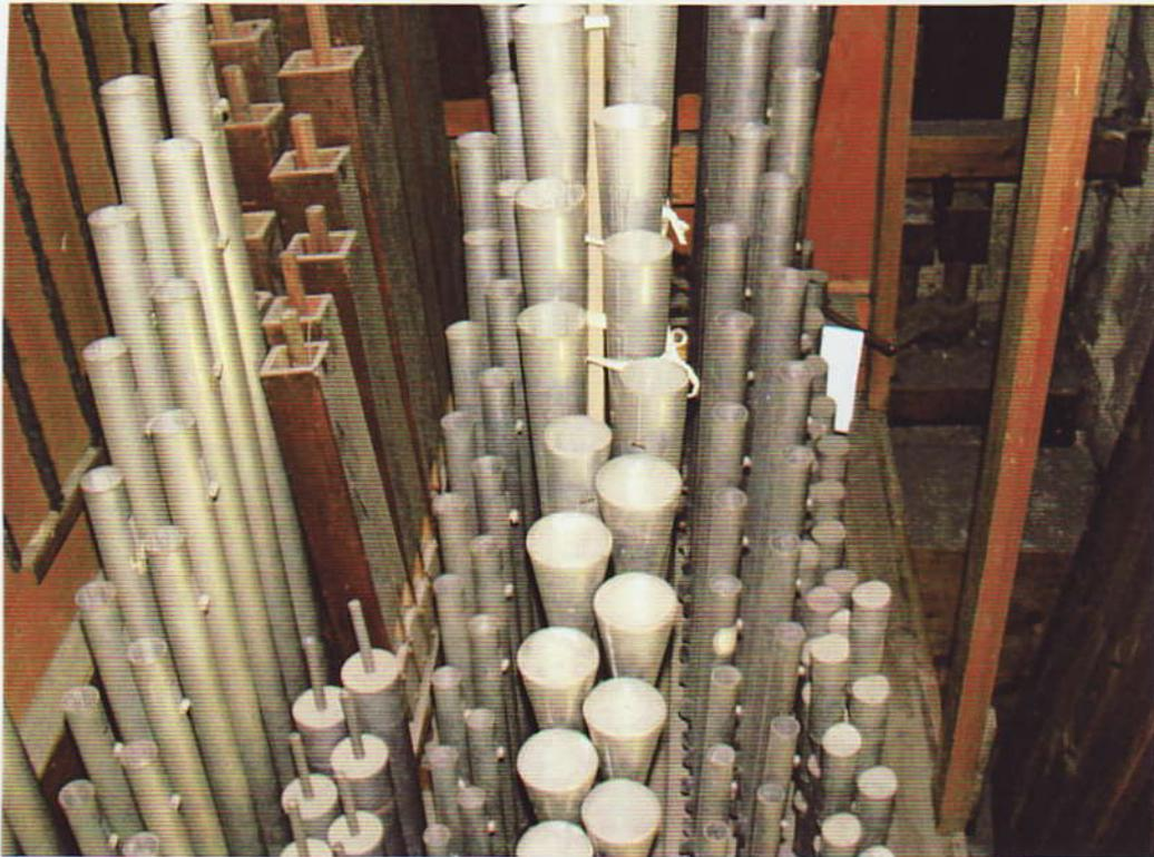
On voit sur cette photo les basses du Cor de Nuit, ce sont des tuyaux avec manchons en chêne dont la facture est plus proche de Ducroquet que ceux du grand-orgue. S'agit-il d'une récupération ou d'une sous-traitance ?
