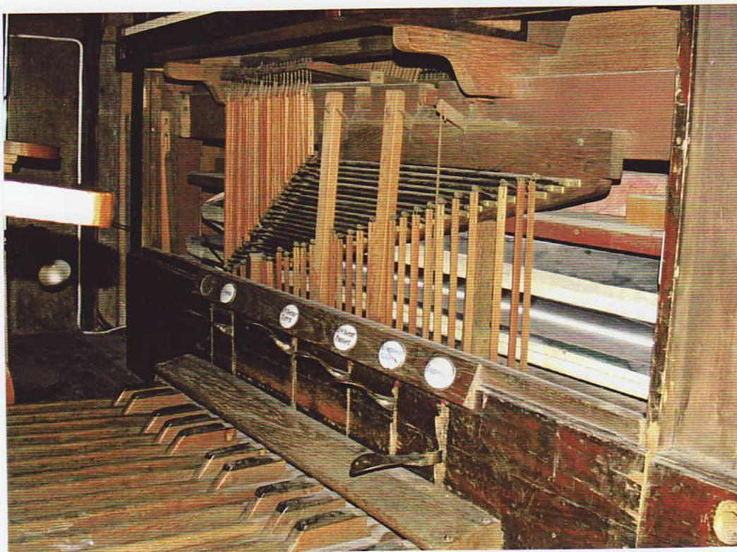
Le mouvement de tirasse est transmis à partir du pédalier par l'intermédiaire d'un balancier puis d'un pilote de renvoi à l'arrière de la touche du premier clavier. Il n'y a qu'un seul point de réglage au balancier, par tige filetée et écrou de cuir. Tous les autres points sont fixes avec des crochets en laiton. Les vergettes ont des garnitures en coton pour les filetages et en papier neutre pour les crochets.
