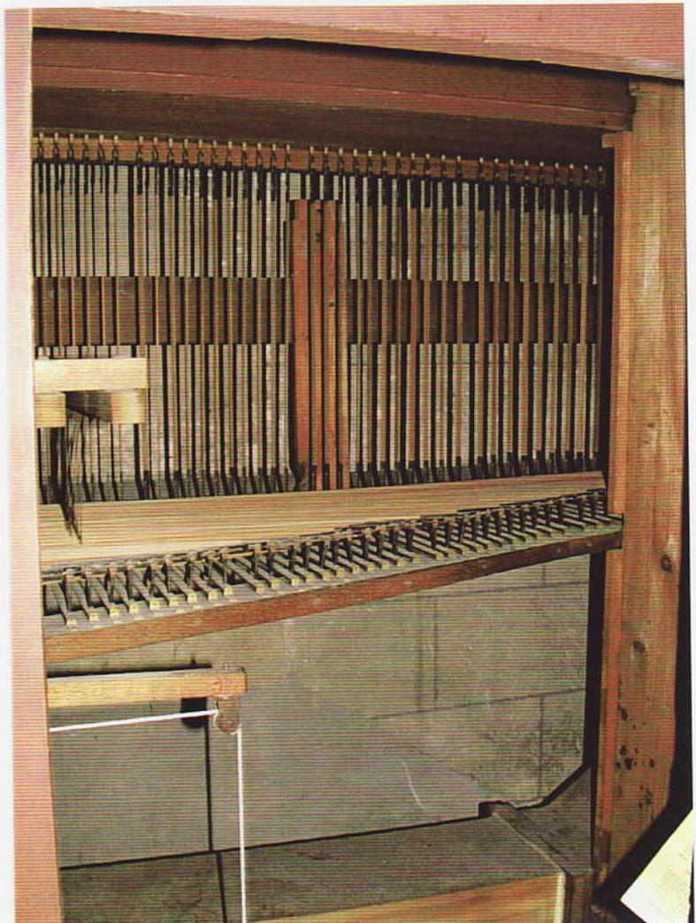
Le premier rouleau a à son extrémité un bras en patte de lapin, le clavier est au-dessus et tire ce rouleau par l'intermédiaire d'un fil réglable. La division est celle du clavier. Les vergettes de liaison sont munis de crochets en laiton sur des garnitures en papier vert. Elles sont fixées sur les bras verticaux et retenues par des fils de soutien en maillechort.
