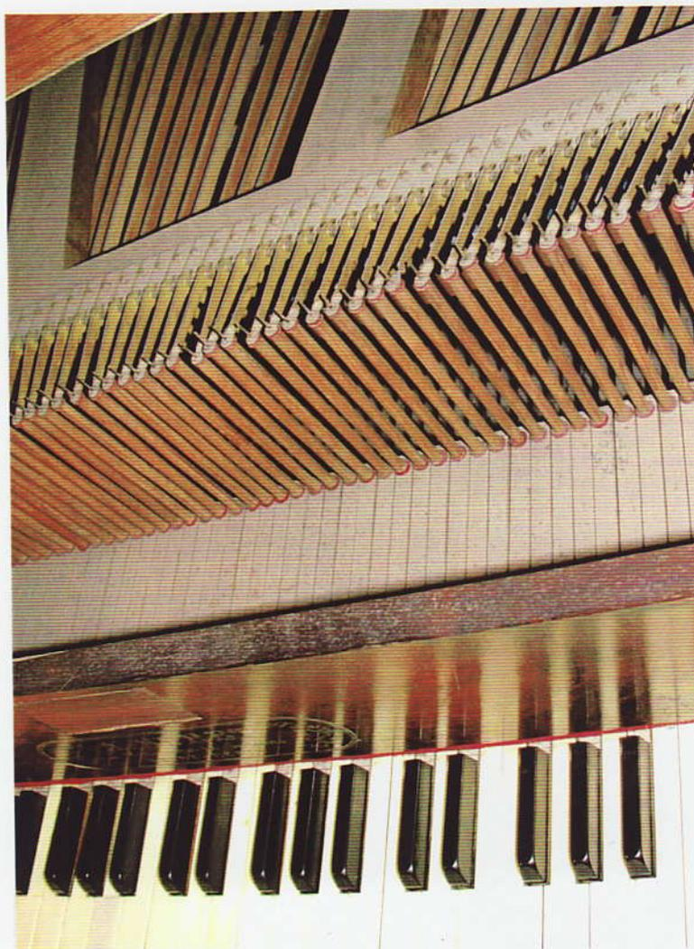
Le démontage se poursuit par la dépose de ce panneau et on accède ainsi aux pilotes du départ mécanique du clavier de récit. La mécanique est entièrement en éventail par le biais de deux barres d'équerres de renvoi. On voit ici la première.
