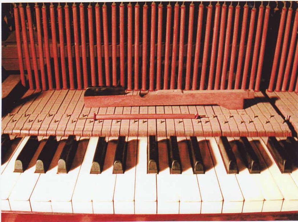
Les touches des claviers sont profilées pour recevoir dans une cuvette la barre de butée qui est un simple fer rond emballé dans un tissu cousu.
