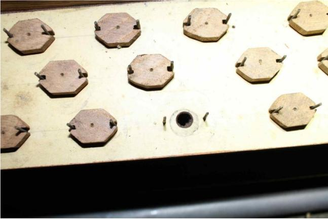
Remplacement des postages pneumatique entre la console et les relais en passant d'un diamètre 9 à un diamètre de 10 mm. Modification du trajet de ces postages pour qu'ils ne traversent plus les trains de vergettes sous la console.
