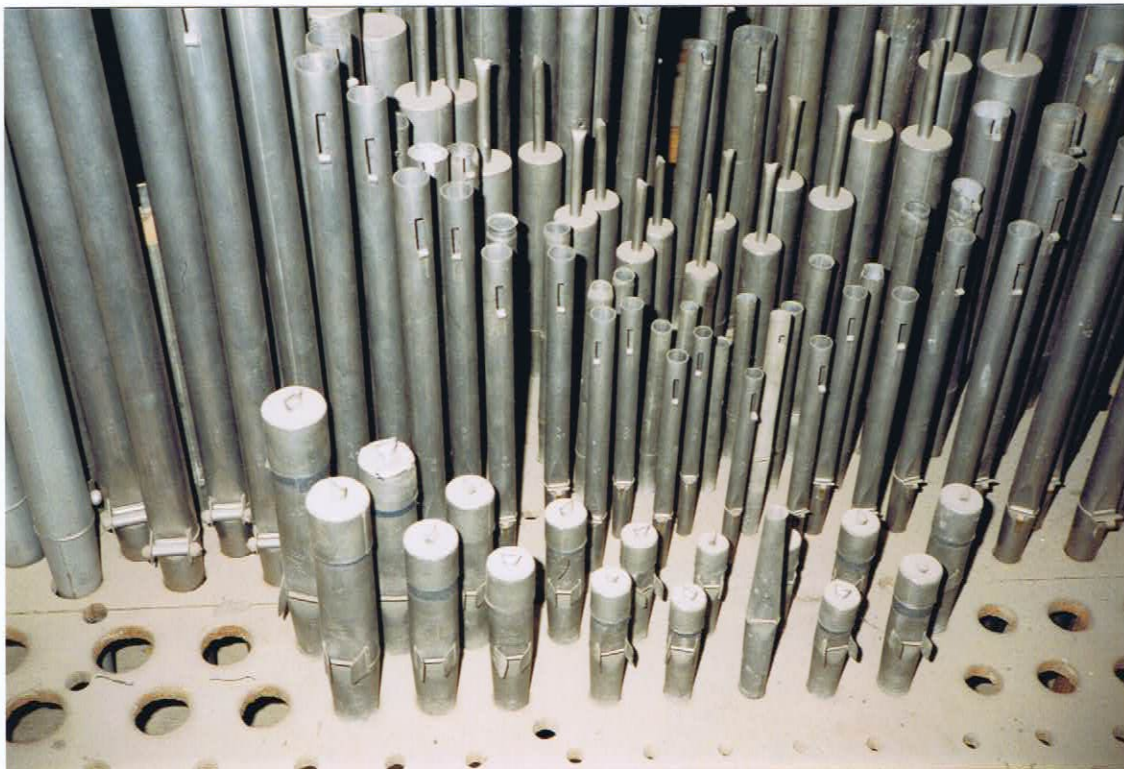
(16) Tuyaux au démontage - cheminées coupées et pincées du Bourdon 8'.
