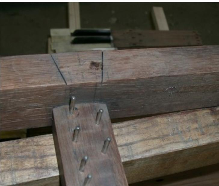
Le Clavier de Positif a été initialement fabriqué pour une mécanique suspendue (touches axées en queue) puis modifié pour une mécanique à bascule. On voit sur les photos l'assemblage ajouté pour la barre support des pointes axes (à gauche) et au contraire les traces des assemblages à queue droite qui ont été sciés lors du changement (ci-dessous)
