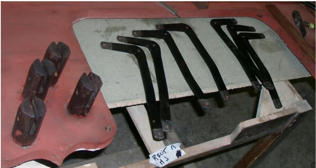
Les équerres de mécanique jeux du Récit pour le renvoi vertical du tirage contre le mur du fond. L'effet de levier est d'environ 1 à 3, ce qui permet un tirage assez doux à la console. Les supports sont en chêne de section octogonale (récupération de tournants de jeux de Grinda).
