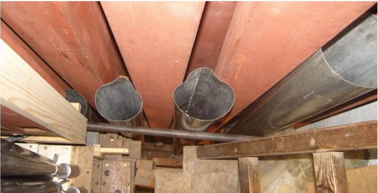
La Trompette de Pédale côté dièse (de la pédale, donc côté C du G.O.) est complètement « coincée » entre les pavillons de Bombarde 16, la mécanique de jeux du G.O. (liens et sabres) et les barres de fer maintenant le buffet solidaire du mur.
