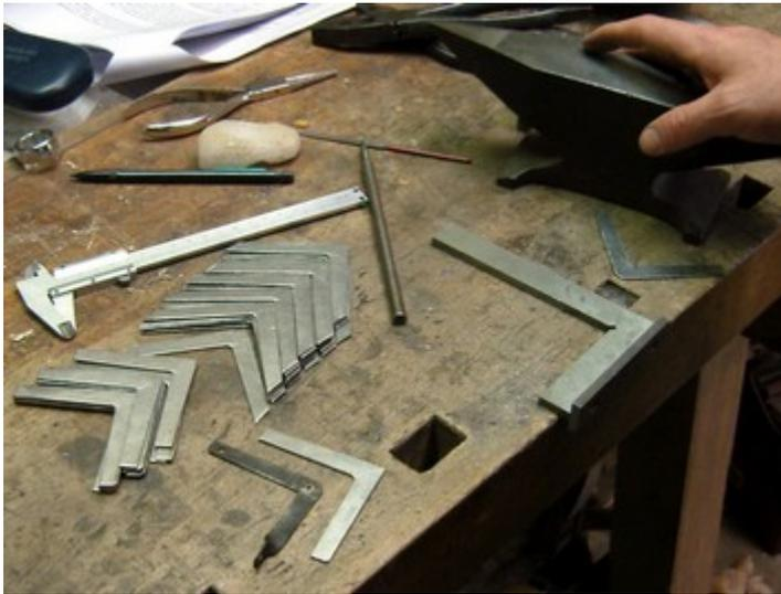
La fabrication des équerres en tôle de fer d'épaisseur d'environ 1.5 mm. Découpées une à une et, arrondies percée et tordues comme l'étaient les anciennes.
