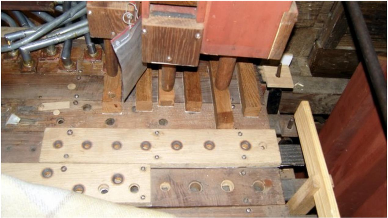
Les tuyaux du Prestant 4 et du Salicional 8 ne pouvait pas être placés directement sur les trous des chapes. Ils ont été déportés sur le sommier à l'aide de ces surchapes. On distingue aussi les petits pontons de bois servant à relier les perces de la basse de Montre 8 et celles du Salicional 8 (basses communes). Les postages d'alimentation de ces pontons ne sont pas encore posés.
