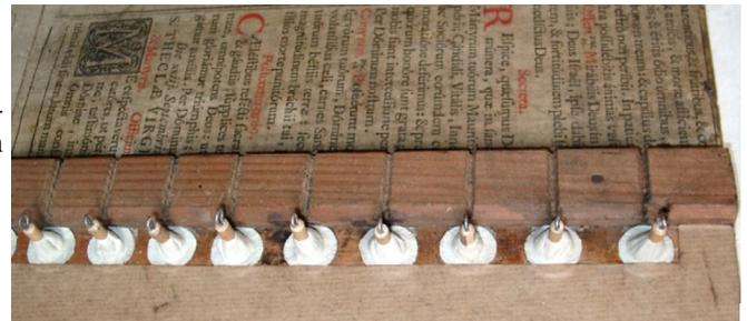
Pour pouvoir mettre en place la nouvelle disposition des jeux sur les chapes anciennes (avec de légères modifications par rapport à la disposition d'origine de Grinda pour pouvoir placer le Salicional de Puget). Il a fallu déporter sur chape quelques basses du Salicional et du Prestant (qui était probablement posté sur les côtés à l'origine).
