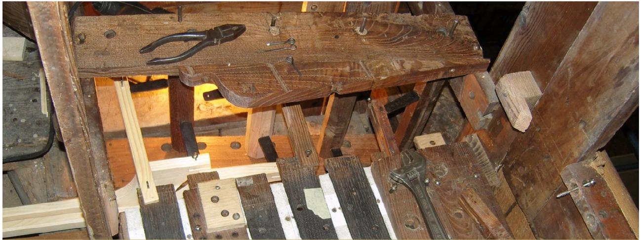
La mise en place et les modification du tirage des jeux du Positif côté Ré, ont entraîné un remplacement des tirants.
