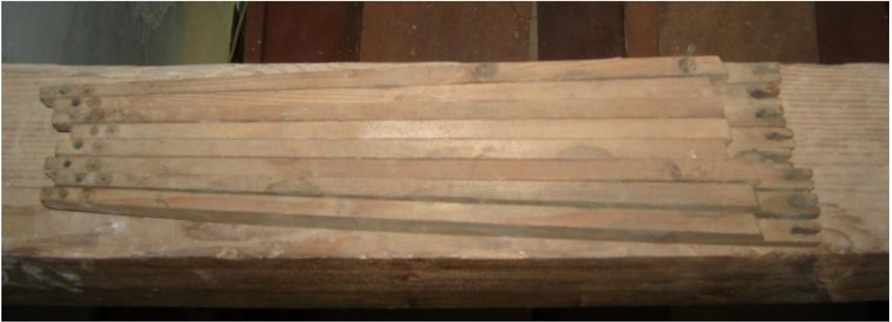
Ces balanciers, vestiges de la mécanique de Grinda, sont entreposés au dessus de la soufflerie.
