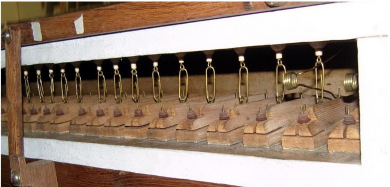
Souples du Récit en place avec des accroches permettant le guidage du ressort qui est placé à l'envers, de manière à conserver un accès facile à sa boucle.
