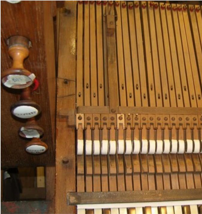
Les masselottes du G.O. sont en place avec leur commande; On distingue bien les mortaises de passage des axes des touches du Positif.
