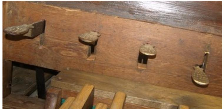
A l'arrière des contre touches de pédale, une particularité étonnante de Puget : le mouvement poussant de bas en haut se fait par une vergette de forte section avec un filetage en laiton de fort diamètre.
