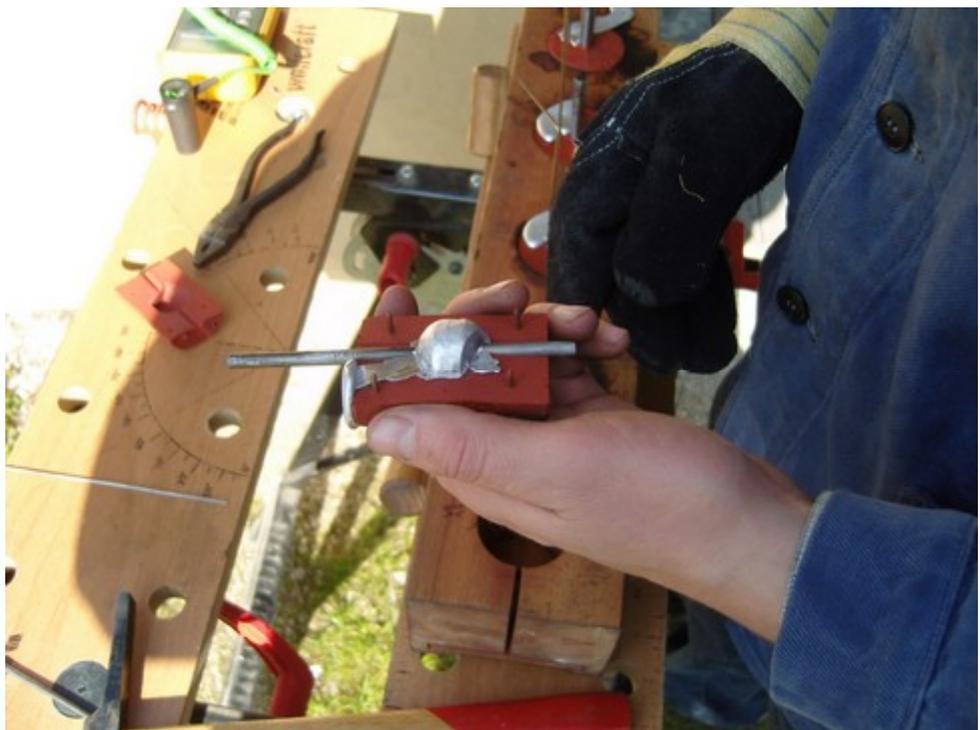
Coulage des noyaux à Olives pour les Trompettes de Grinda; D'autres moules ont été fabriqués pour les bagues et les noyaux des chamades.
