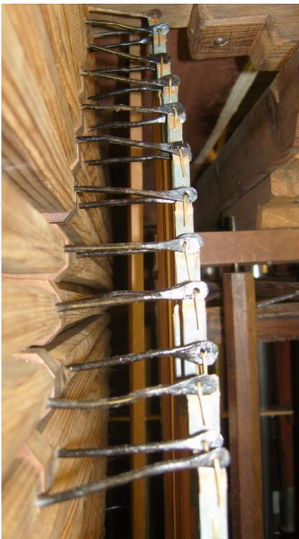
La planche d'abrégé et les craudaudines doubles après la redépose de la mécanique G.O.
