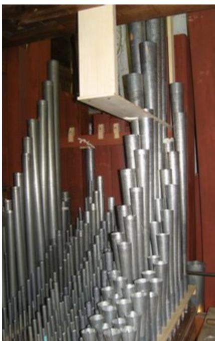
La tuyauterie du G.O. côté do : Les trompette et clairon sont en place; le support des pavillons de Trompette est inspiré du support que Puget a placé à la pédale
