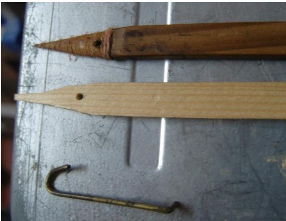
Détails sur la fabrication et le mode d'accrochage des embouts de laiton sur les vergettes de Puget.
