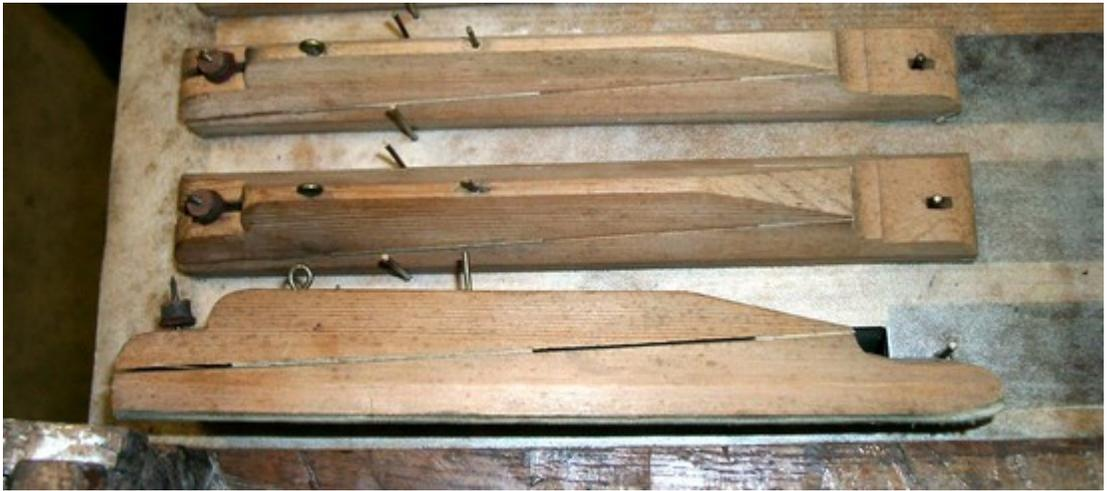
Les soupapes du Récit de Puget sont à double déclenchement pour éviter la résistance au décollement
