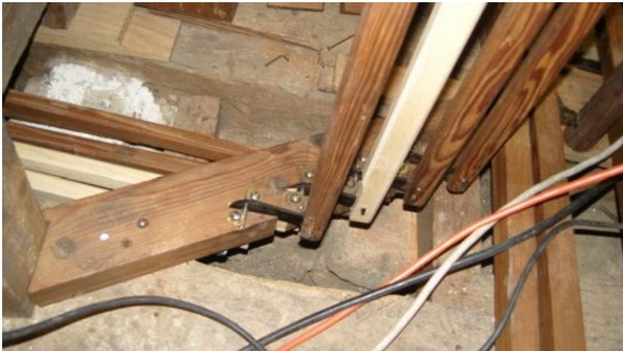
Différentes vues sur la mécanique des jeux du Positif côté dièse et les différentes modifications qu'il a fallu faire (4 jeux de ce côté au lieu de trois dans la disposition de Puget).
