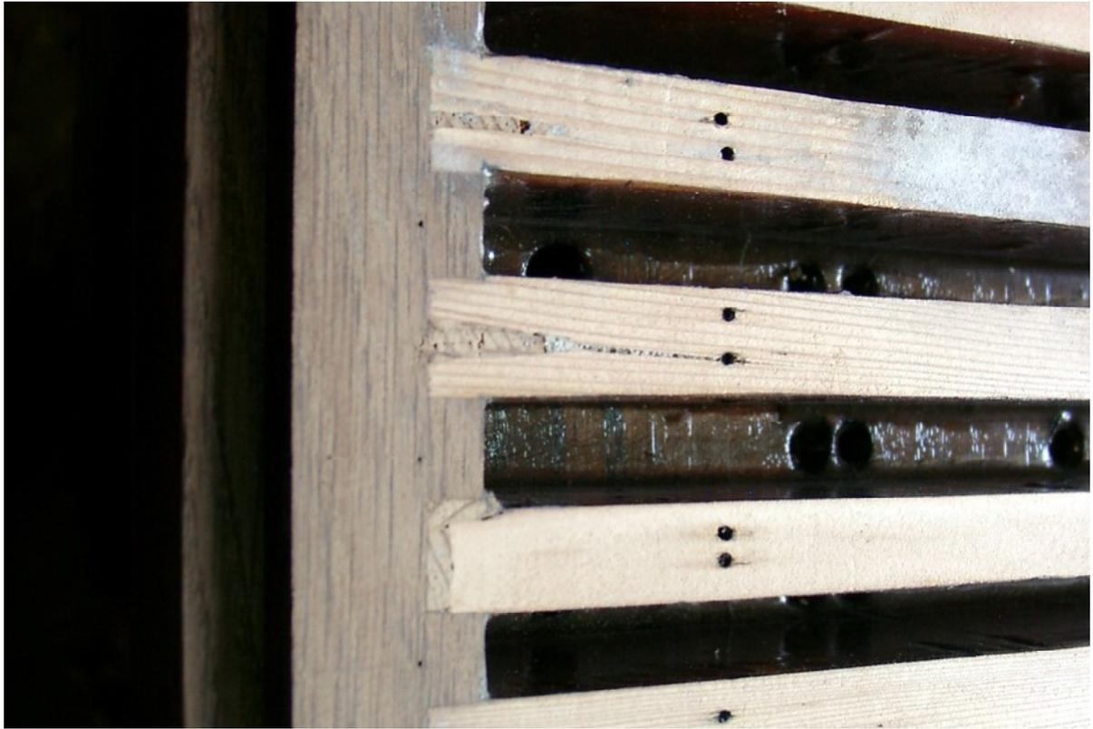
Les barrages de sapin sont reliés au cadre par des denticules sciés dans la masse. Grinda a placé des coins pour ajuster les largeurs de barrage.
