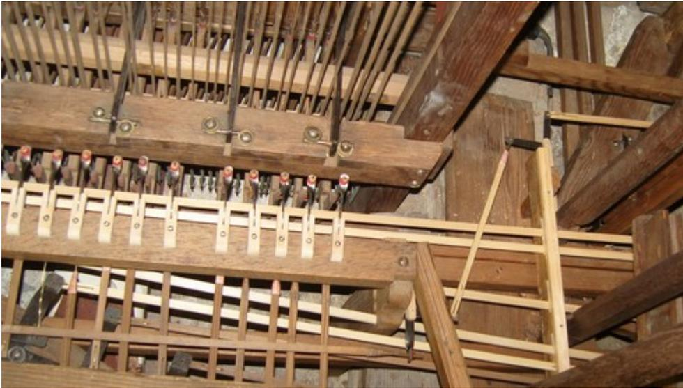
La mécanique de pédale avec ses renvois horizontaux et parfois des tracés peu orthodoxes comme ci-dessus pour le F2
