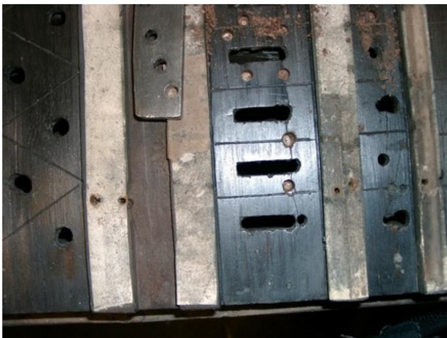
Des trous sont percés dans toutes les fentes reliant deux ou plusieurs notes. Ils sont percés jusque dans le barrage et recevront des petits bouchons
