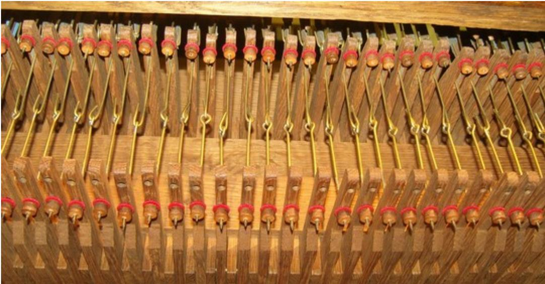
Vue sur la mécanique de renvoi du Récit et du G.O au dessus du bloc des claviers. Les perces au premier plan étaient prévues pour un accouplement qui n'a jamais été posé (accouplement à masselottes présent entre les claviers).
