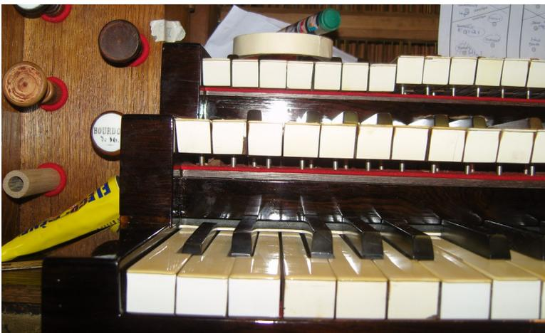
Accrochage du clavier de Positif. On voit les balanciers de la tirasses de pédale a travers lesquels passent les fils de commande de ce plan sonore.
