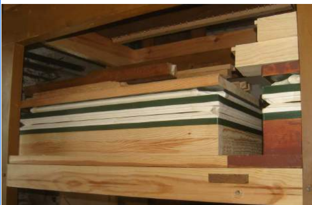
Le nouveau réservoir du Positif et celui du Grand orgue avec ses trois entrées de porte-vent
