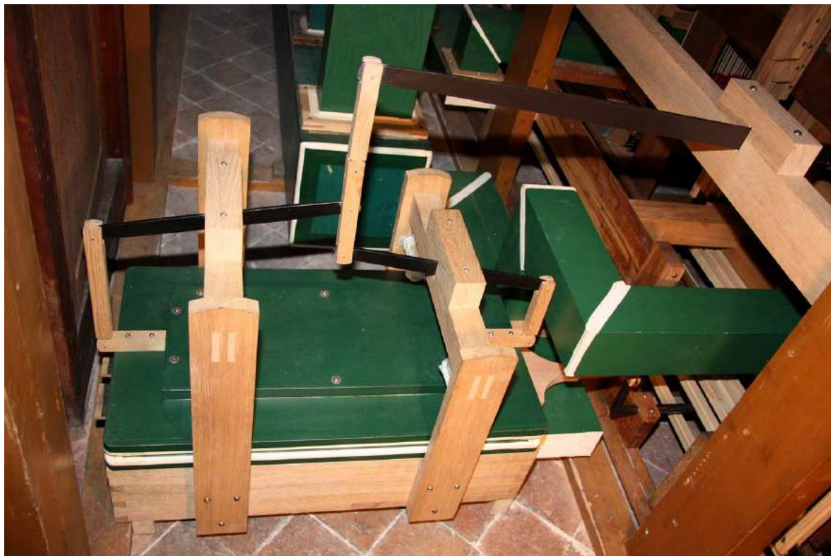
Le Forte mis en place, avec sa mécanique d'entraînement de tous les appels d'anches
