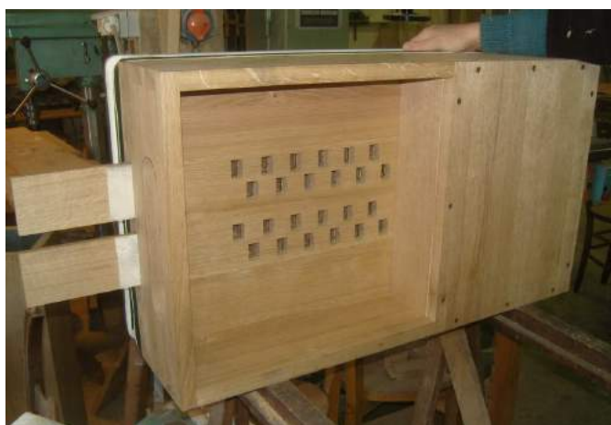
Le Forte mis en place, avec sa mécanique d'entraînement de tous les appels d'anches
