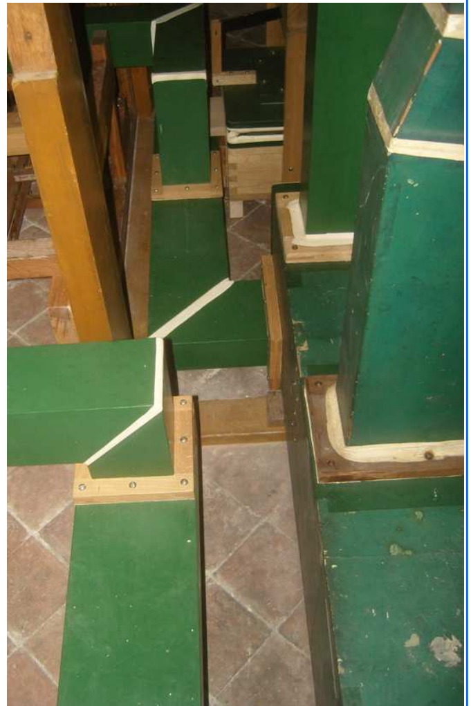
Alimentation des Barker depuis les emplacements anciens sur le portevent collecteur
