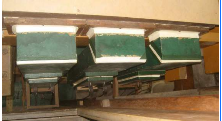
Les trois porte-vent alimentant le sommier du G.O. avec leurs antiscousses
