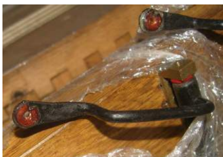
Abrégé de pédale avant et après restauration
