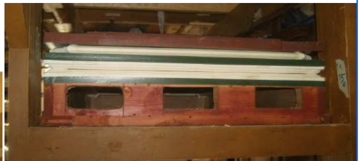
Le nouveau réservoir du Positif et celui du Grand orgue avec ses trois entrées de porte-vent
