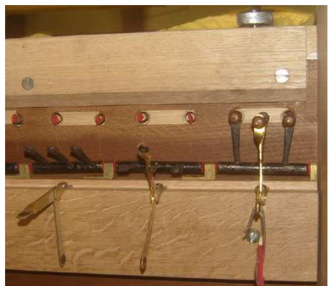
Les double soupapes du G.O sont maintenant reliées par un rouleau d'abrégé d'origine placé à l'extérieur de la laye
