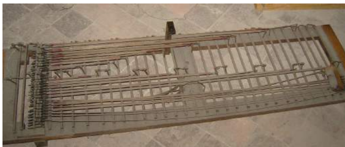
Abrégé de pédale avant et après restauration
