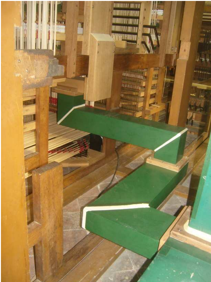
Alimentation des Barker depuis les emplacements anciens sur le portevent collecteur
