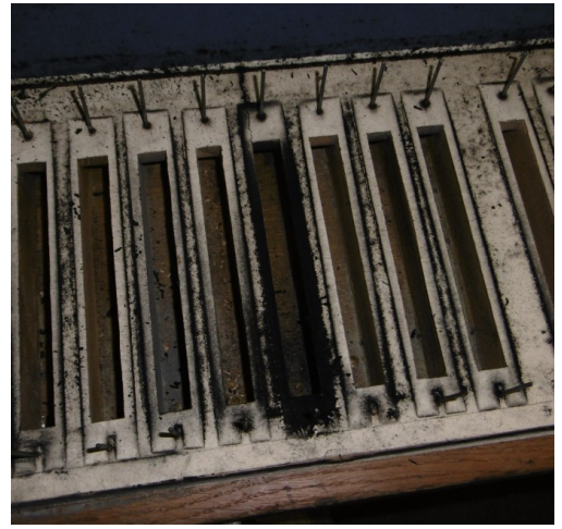
Ci-dessus à gauche : soufflets des étages supérieurs fixés par l'avant à travers la traverse et la peau préalablement brûlée. A droite, traces laissées par les soupapes à l'intérieur de la laye, montrant d'important défaut d'étanchéité de celles-ci.
