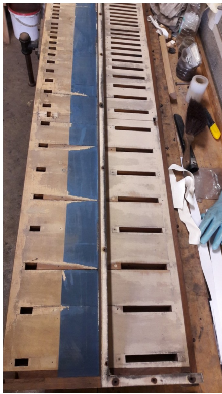
Ci-dessus à gauche : soufflets des étages supérieurs fixés par l'avant à travers la traverse et la peau préalablement brûlée. A droite, traces laissées par les soupapes à l'intérieur de la laye, montrant d'important défaut d'étanchéité de celles-ci.
