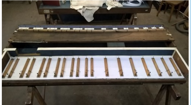
Sommier restauré, prêt à être remonté.
