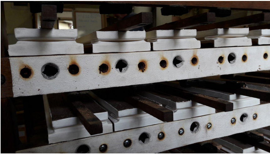
Ci-dessus à gauche : soufflets des étages supérieurs fixés par l'avant à travers la traverse et la peau préalablement brûlée. A droite, traces laissées par les soupapes à l'intérieur de la laye, montrant d'important défaut d'étanchéité de celles-ci.
