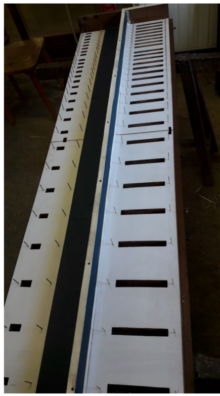
Ci-dessus à gauche : soufflets des étages supérieurs fixés par l'avant à travers la traverse et la peau préalablement brûlée. A droite, traces laissées par les soupapes à l'intérieur de la laye, montrant d'important défaut d'étanchéité de celles-ci.
