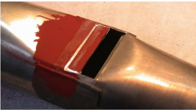
Plaque après soudure faite dans les règles de l'art.
