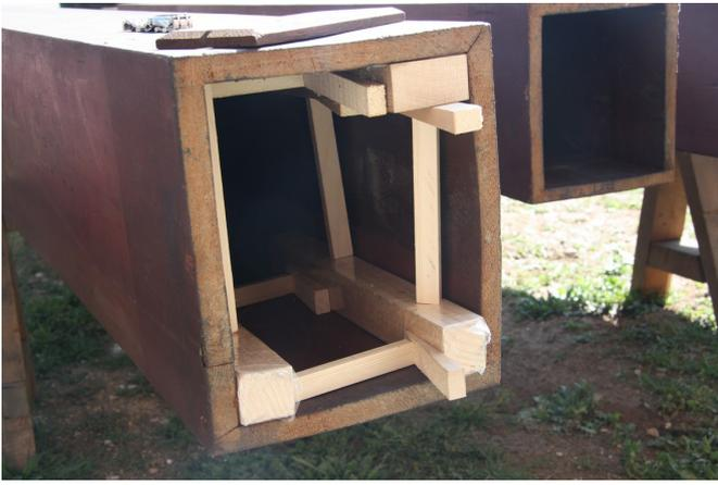
Les tuyaux qui présentait des fentes au niveau des joints de collage ont bénéficié de la pose en renfort d'étanchéité de bandes de parchemin. Le soleil ce jour-là a permis un séchage au chaud de la colle chaude, conditions idéales !
