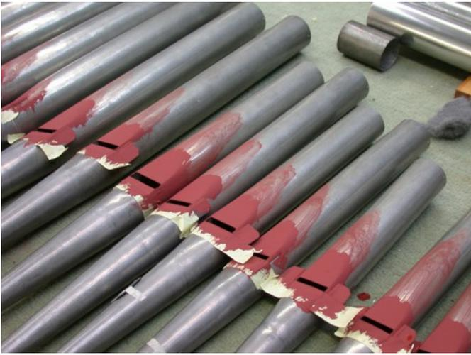
Préparation des tuyaux avant soudure d'un plaque pour baisser la bouche dans les règles de l'art.
