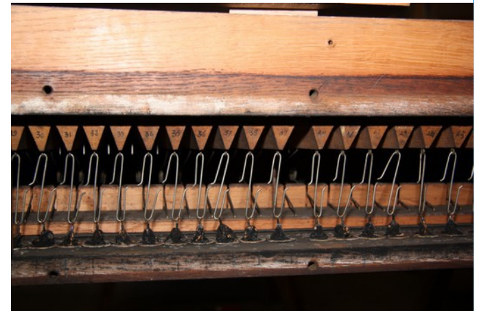
Le sommier de Récit après ouverture des tampons de laye : si les boursettes ne sont pas d'origine, les esses le sont probablement.
