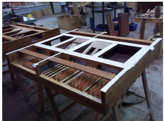
Sommier après la pose des nouveaux joints d'étanchéité avec les planches de fonds de sommier.
