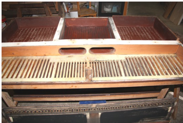
Sommier de récit, après démontage des soupapes. Sur la photo, le côté gauche a été nettoyé et le côté droit pas encore. On peut remarquer au bas l'encrassement de la planche à bourses (fond de sommier souple).
