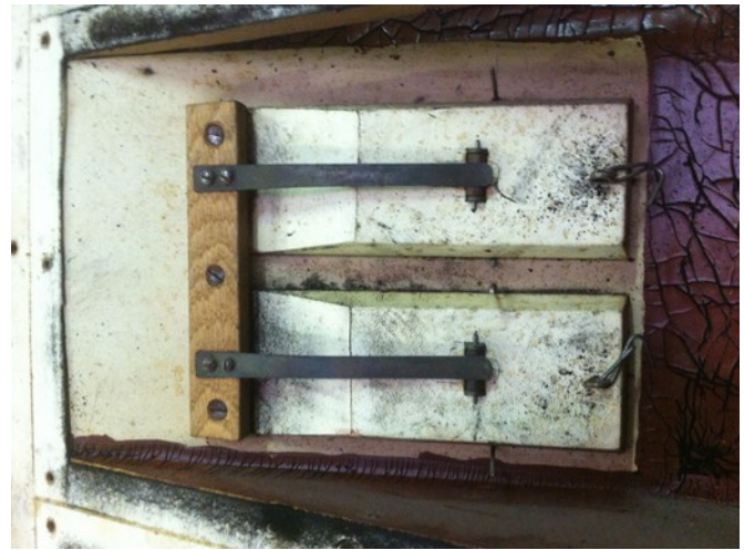
Mécanisme d'appel d'anche avant nettoyage.
