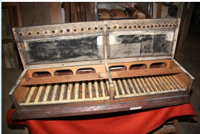
Sommier du positif après ouverture. On aperçoit les pièces de peau posés probablement par Mutin sur les fonds de laye souples recouverts de tissus par Cavaillé-Coll
