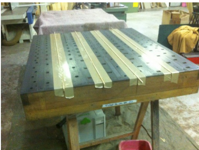
Planche à bourses des appels d'anches. Ces bourses de grande taille ont fréquemment du être refaites car le cuir, très fragile résistait difficilement au démontage des eses les reliant aux soupapes dont les ressorts étaient très rigides.
