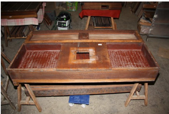
Une fois retourné, le sommier de Récit présente des fuites diverses sur le fond : parties en cuir fermant les grilles et planche recevant l'arrivée en vent.
