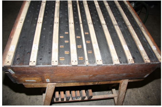
Le démontage des chape sur le sommier de Récit : les faux registres sont fixés à l'aide de tourillons, ce qui permet de les retirer assez facilement.
