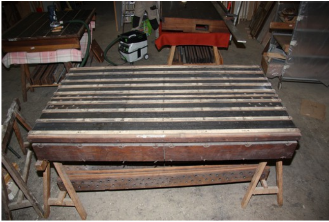
Le démontage des chape sur le sommier de Récit : les faux registres sont fixés à l'aide de tourillons, ce qui permet de les retirer assez facilement.
