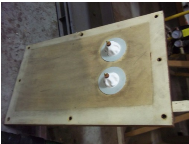
Planche à bourses des appels d'anches. Ces bourses de grande taille ont fréquemment du être refaites car le cuir, très fragile résistait difficilement au démontage des eses les reliant aux soupapes dont les ressorts étaient très rigides.
