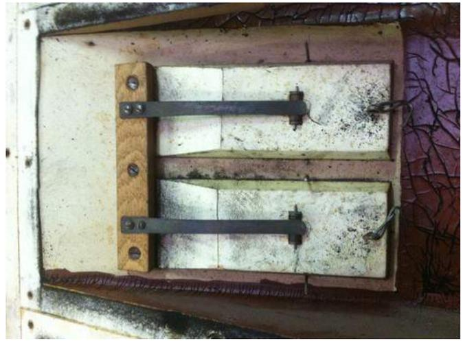
Mécanisme d'appel d'anche avant nettoyage.
