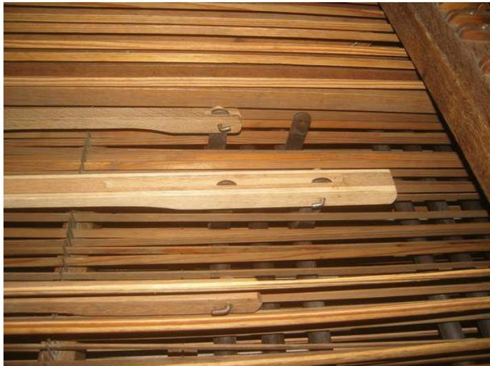
Trains de vergettes superposés sous le plancher reliant la console au buffet. On distingue au centre les modifications, complètement réversibles, apportées aux rouleaux et aux tirants des commandes de boîtes expressives. En effet, la bascule de droite, commandant au départ le Récit, commande désormais l'Eoline, placée avant au centre. Ainsi, les boîtes du Positif et du Récit, peuvent être maniées en même temps pour un effet cumulé.
