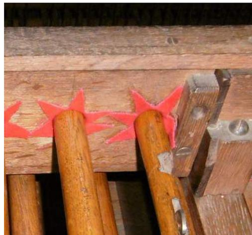
Les cravates en casimir, très usées, ont été déposées pour être remplacées. Ce n'étaient pas les cravates d'origine (voir photo de gauche) car les anciennes avaient un retour de collage à l'arrière des gratins en chêne (en étoile). Ces traces étaient encore visibles (photo de droite, tirant le plus à droite).
