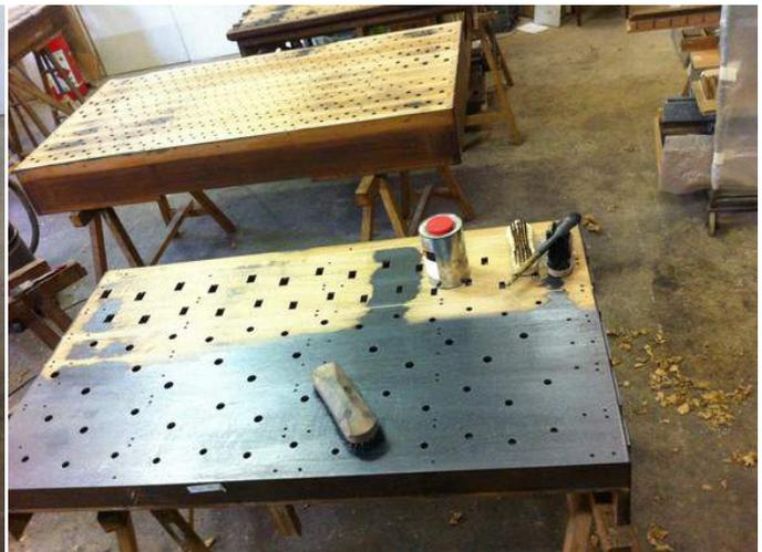
Les flippots sont ensuite affleurés à la main puis la totalité de la table est dressée à la varlope. Le dressage à la varlope laisse toujours des zones de graphite visible car il ne faut pas descendre trop bas : c'est inutile et cela diminue l'épaisseur de la table, la fragilisant.
