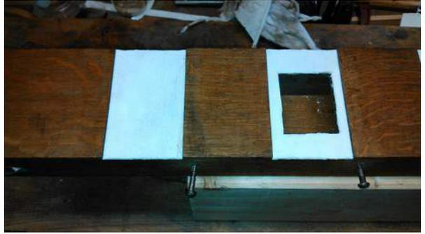
Les montants de la machine sont des porte-vent qui alimentent chacun des tiroirs. Les jonctions d'étanchéité ont été repeaussées car elles avaient souffert de manipulation visant à sortir les tiroirs sans démonter la machine complète (c'est en effet le seul moyen d'accéder aux layes des tiroirs).
