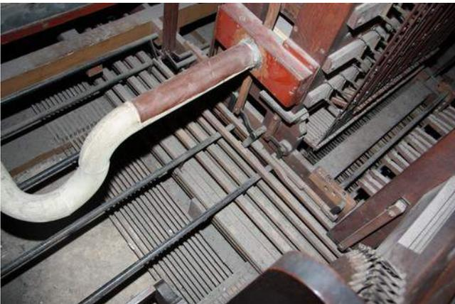
De même, l'alimentation de la Barker a été modifiée : un tuyau en zinc est raccordé sur le côté de ce qui reste d'un porte-vent, bouché sur l'arrière, auparavant relié directement au porte-vent central reliant le réservoir forte pression aux sommiers.
