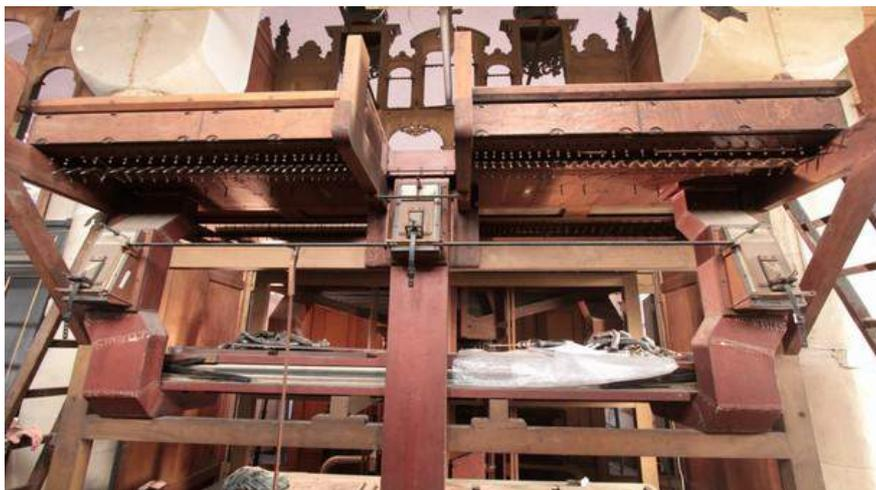
Aux deux extrémités, les porte-vents reliant le réservoir basse pression et les graves de chaque sommier. Au centre, le porte vent venant du réservoir haute pression pour alimenter les aigus
