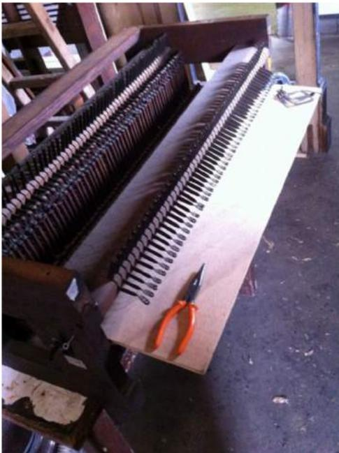
Le bloc mécanique situé au-dessus de la machine et contenant les systèmes d'accouplement a été entièrement démonté, nettoyé et reréglé. Les oeillets ont du être partiellement refait (surtout ceux situés à l'extérieur de la machine et reliés au Récit).
