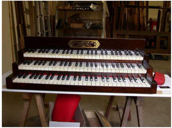
Les claviers après leur restauration, en atelier. Au final, le GO a été pratiquement intégralement replaqué à neuf ; le POS en partie et le Récit uniquement par zone, en utilisant pour ces deux plans sonores les ivoires récupérables des deux autres claviers.
