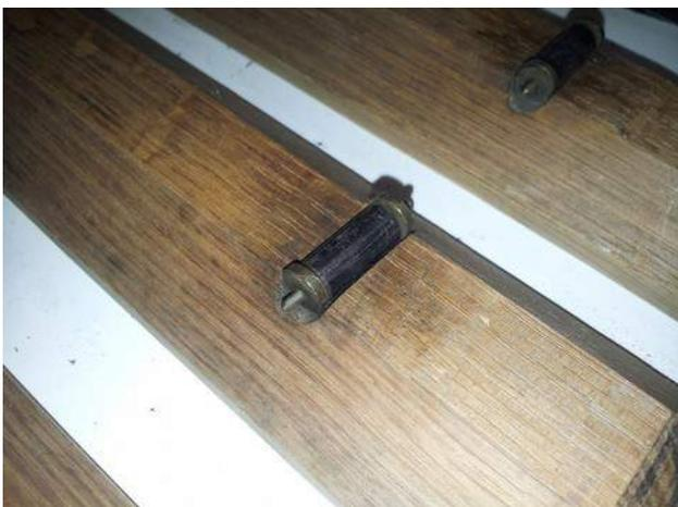
Gros plan sur les soupapes après leur nettoyage et décapage complet.
