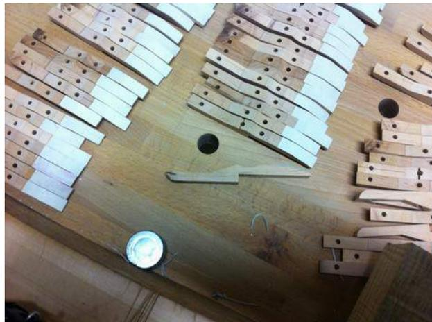
Fabrication des rallonges de touches du Récit. Elles sont en poirier également. Leur extrémité, qui est foulée par les pilotins, a été recouverte d'une fine peau de façon à favoriser le glissement des pilotins lorsque l'accouplement est mis pendant que des touches du Récit sont enfoncées et surtout pour limiter le bruit des pilotins qui les heurtent.
