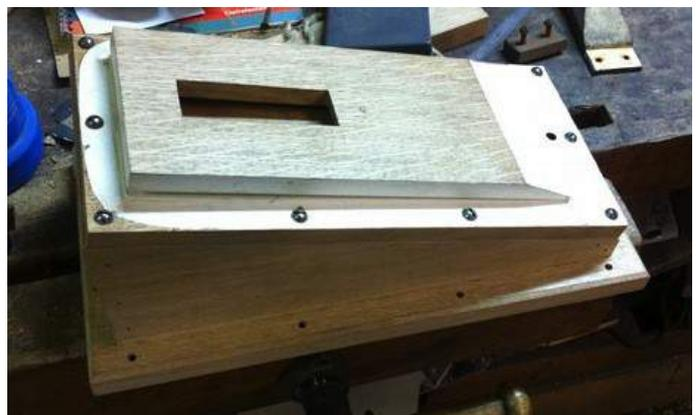
Le trémolo du Récit en cours de fabrication. A gauche, le ressort de la soupape d'admission, située à l'intérieur du trémolo, au niveau de l'ouverture dans le porte-vent. On peut voir que le ressort et son support, neufs, sur le dessus, ont été réalisés en copie de facture de l'ancien (au-dessous-). La photo de droite montre le trémolo en cours d'assemblage.
