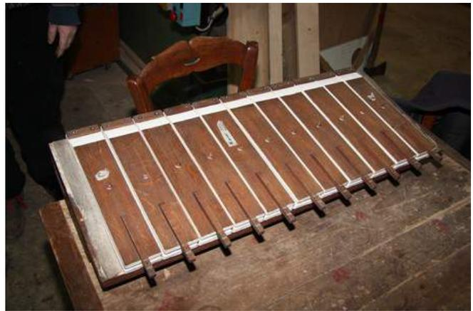
Ensemble de soufflet d'un tiroir, repeaussés et prêts à être remontés. Toutes les pièces ont été établies pour être remontée à leur place de démontage exacte.
