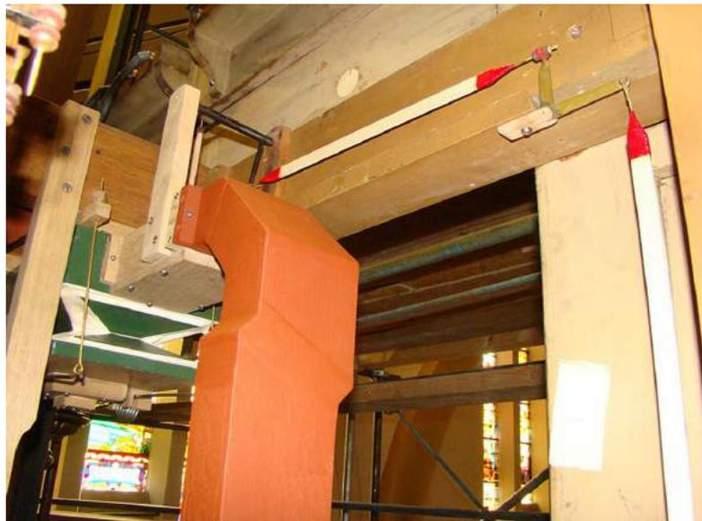
On peut voir que le rouleau commandant le coupe vent a deux supports dont un était toujours fixé à la charpente au moment du démontage. Il a suffi de reconstituer l'autre accroché au porte-vent contenant la soupape de coupe vent.
