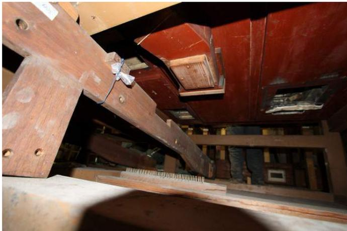
Sous le réservoir haute pression : un ancien départ horizontal (vers Barker ?) et une arrivée verticale bouchée (ancienne alimentation venant du Primaire ?).
