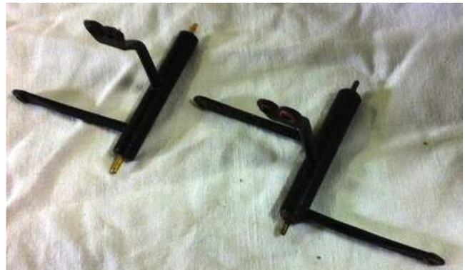
Les relais en cours de fabrication. Les barres sont tournées au bon diamètre (ci-dessus en haut), les bras sont forgés à la main et décollétés au tour à métaux pour être ensuite matés en force dans les barres (ci-dessus à droite). Puis le tout est mis en peinture au noir de ferronnerie.
