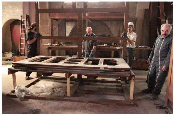
Pour sortir le réservoir Forte pression du GO/POS, en bas, il fallait impérativement « ouvrir » la charpente GO/POS par l'avant et le faire glisser vers l'avant. Impossible de la passer par le côté, comme pour le réservoir Basse pression (haut).
