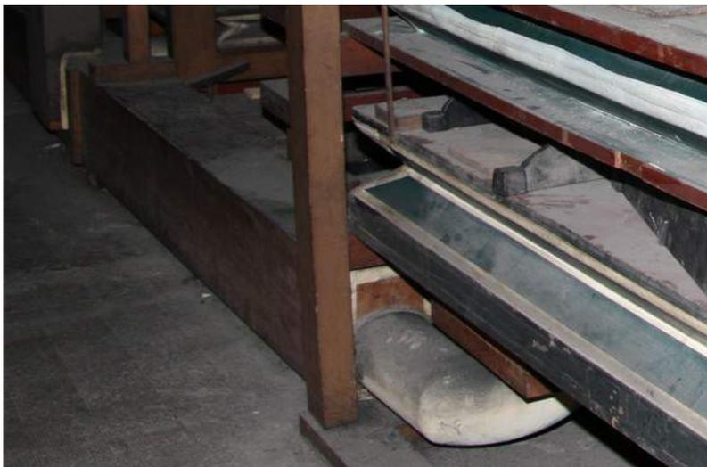
Au démontage, un porte-vent en zinc de forte section arrivait directement dans le régulateur en chêne situé sous le premier réservoir de la soufflerie de Récit. Il venait du gros collecteur principal, relié au réservoir primaire.
