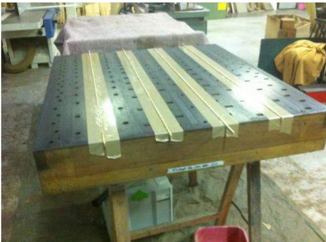
Sommier après pose des flippots au niveau des joints de collage qui s'étaient fissurés.
