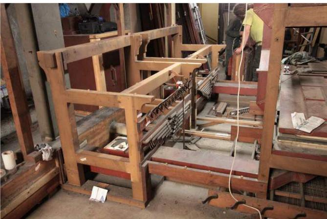
Le porte-vent reliant les réservoirs G.O et pédale servant maintenant à l'alimentation du réservoir Haute pression
