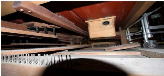
Sous le réservoir haute pression, la boîte de Mutin d'ou partent les porte-vent de zinc pour l'alimentation de la Barker
