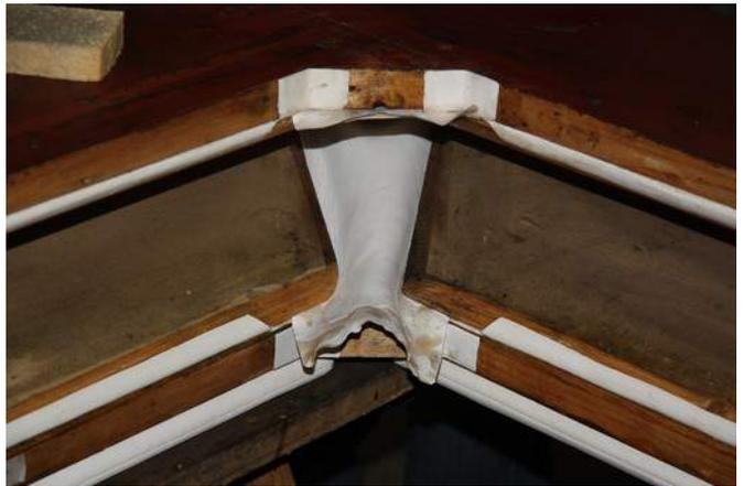
Le pli est ouvert maintenu par des cales et serre-joints. Un gabarit de découpe pour la confection des aines est préparé par rapport aux aines anciennes décollées et par rapport aux dimensions relevées sur le plis ainsi maintenu.
