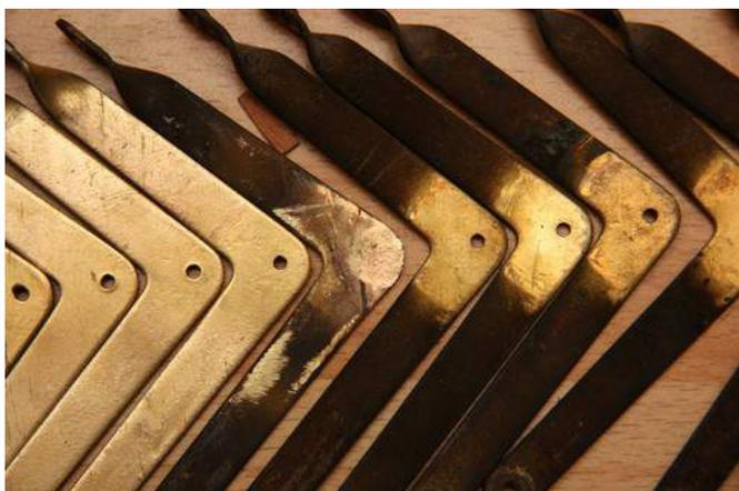
Le nettoyage des équerres se fait avec un bain de vinaigre. Celui-ci est intégral si les garnitures de cuir sont manquantes ou « cuites », partiel si elles sont récupérables. Il a fallu changer environ les 2/3 des oeillets de l'instrument, tant au niveau des barres d'équerre que des abrégés.
