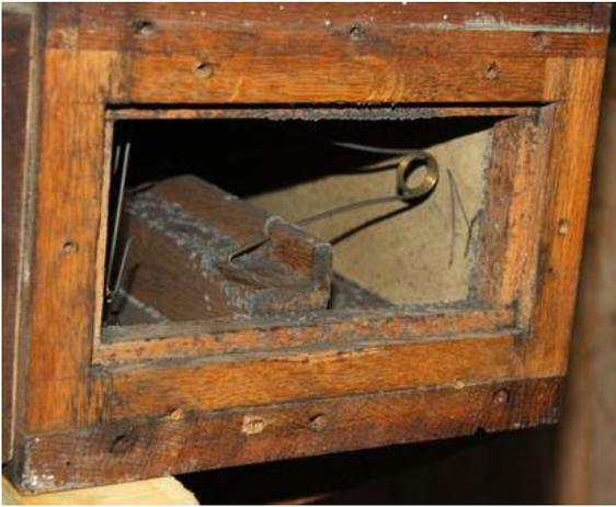
Les perçages retrouvés sur ces sommiers au démontage ont montré que les porte-vents d'origine étaient de section rectangulaire, qu'ils s'inséraient sur 1 cm à l'intérieur de sommier, ce qui nous a donné leur section intérieure. On voit sur la photo ci-contre les perçages d'origine (2 en haut, 2 en bas, 1 de chaque côté de l'ouverture).
