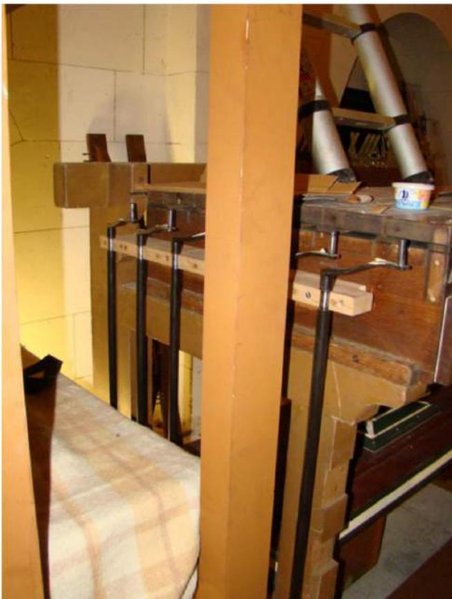
Les rouleaux verticaux commandant les registres des sommiers de pédale, après leur mise en place au remontage. Les rouleaux anciens ont pu être réutilisés et intégrés dans le nouveau trajet mécanique.
