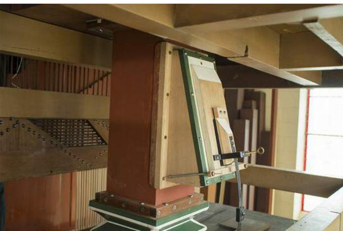
Le trémolo de Récit lors de son installation sur le porte-vent alimentant le sommier. Il a suffi de retirer la plaque bouchant l'ouverture ancienne et de fixer le nouveau trémolo. La commande a été ajoutée ensuite, en utilisant l'encoche que l'on peut repérer dans la charpente soutenant le plancher d'accès au Récit : un tourillon long y a été placé, pour commander l'ouverture de la soupape intérieure.
