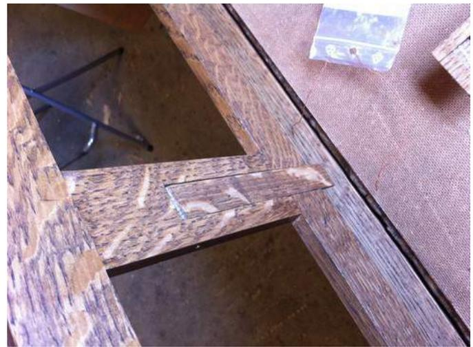
La pique arrière, contenue dans l'épaisseur du montant central, maintient l'inclinaison.
