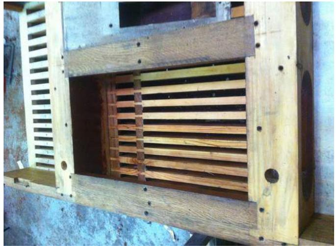
Le fond de la grille, recouvert de peau, servant à rendre étanche les gravures, avant et après décapage de la peau. On distingue les prisonniers (blocs de bois pris entre deux barrages) qui séparent les anches des fonds pour une même gravure (sur la photo de droite).
