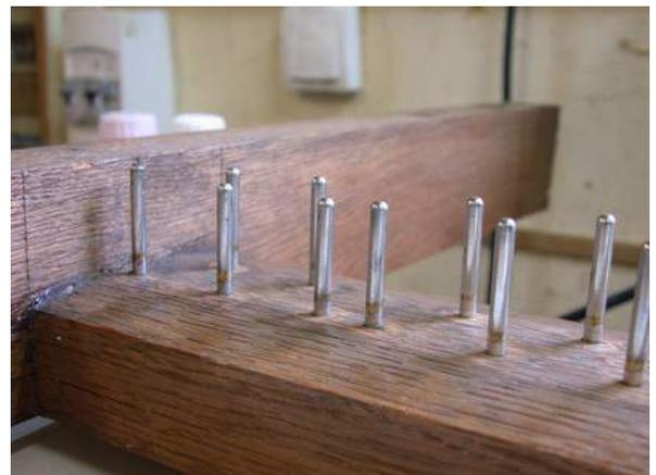
Les châssis de clavier ont été également restaurés : les garnitures usées et mitées ont été changées et les axes parfaitement désoxydés et redressés pour supprimer tout frottement.
