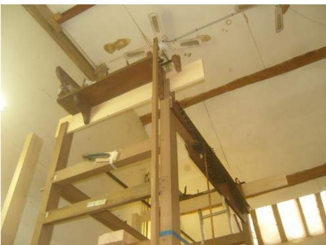
Il a fallu monter intégralement les éléments de la mécanique du Récit pour concevoir les nouvelles liaisons pour les notes et pour les jeux. Ainsi, on peut voir ci-dessus une installation provisoire dans l'atelier pour fixer les blocs de rouleaux de cette mécanique jeu, normalement accrochés à la boîte expressive. Les points hauts étaient ainsi donnés.
