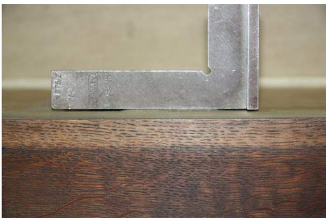
Exemple de barrage décollé, sur un sommier d'extension de pédale. Dans ce cas, les soupapes ne peuvent plus être jointives avec la grille ce qui peut créer des cornements permanents.
