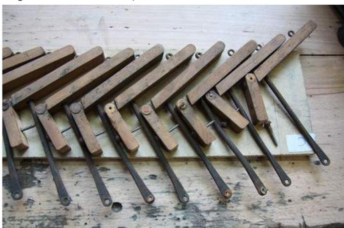
Les contre-touches du pédalier étaient par contre en très mauvais état et causaient de nombreuses pannes. Soumises à de fortes pressions du fait de la mécanique longue et complexe qu'il y a derrière (6 soupapes et plus de 15 mètres de vergettes à tirer pour certaines d'entre elles...), les axes des crapaudines étaient à 80 % hors d'usage.
