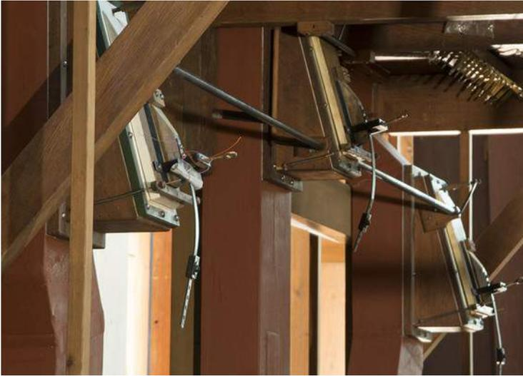
Les trois trémolos du Positif ont été restaurés et donc intégralement démontés. Ainsi, leurs caractéristiques techniques ont pu être relevées afin de fabriquer le trémolo de Récit en copie de facture. On les voit ici au moment du remontage, chacun fixé sur le porte-vent sortant du réservoir, juste avant le sommier, l'un pour la faible pression du côté C (à droite sur la photo), l'autre pour la forte pression C et #, le dernier pour la faible pression côté #.
