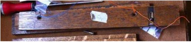
Le pupitre a dû être intégralement reconstitué. En effet, celui d'origine avait disparu au profit d'un autre se limitant à une simple plaque en bois sur ferrures pliées. Comme indications de ce qu'il y avait à l'origine, seuls subsistaient quelques trous dans le couvercle de console ainsi que les deux glissières de côté, retrouvées dans les combles derrière l'orgue. Cela montrait qu'il s'agissait d'un pupitre pliant sur glissière, comme Cavallé-Coll en fournissait régulièrement.
