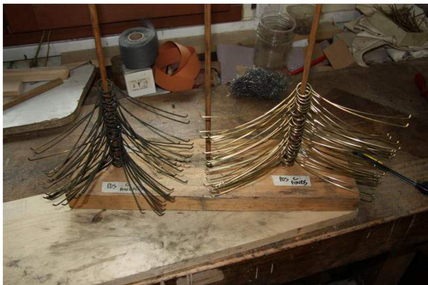
Nettoyage des ressorts : ils sont placés dans un bain à ultrasons (eau additionnée de vinaigre) puis rapidement frottés à la paille de fer ultra fine avant d'être rincés à l'eau claire pour stopper l'action du vinaigre. A gauche sur la photo une série de ressort, dont l'ordre est toujours conservé, avant traitement ; à droite après nettoyage.
