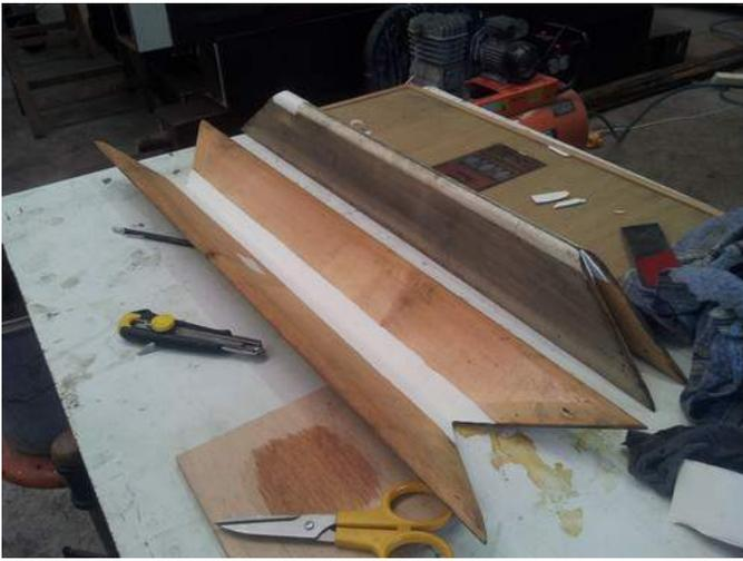
Assemblage des éclisses après nettoyage, décapage et dressage.
