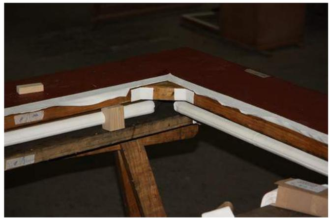
Tout au long des opérations, les écartements sont maintenus par des cales et serre-joints pour garantir un séchage des bandes dans leur extension maximale. Ainsi, elles ne risquent pas de craquer au séchage.
