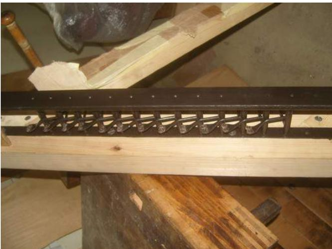
Les relais après montage sur les traverses de la nouvelle semelle, reliant la semelle du GO/POS à celle des sommiers de Pédale. Ci-dessous, montage des vergettes sur le relais. Toutes ont été posées en atelier, une à une.
