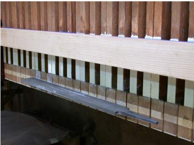
Les ivoires sont collés en laissant les touches en place dans le châssis de façon à pouvoir vérifier les alignements. Ceux-ci sont corrigés à la lime après séchage.
