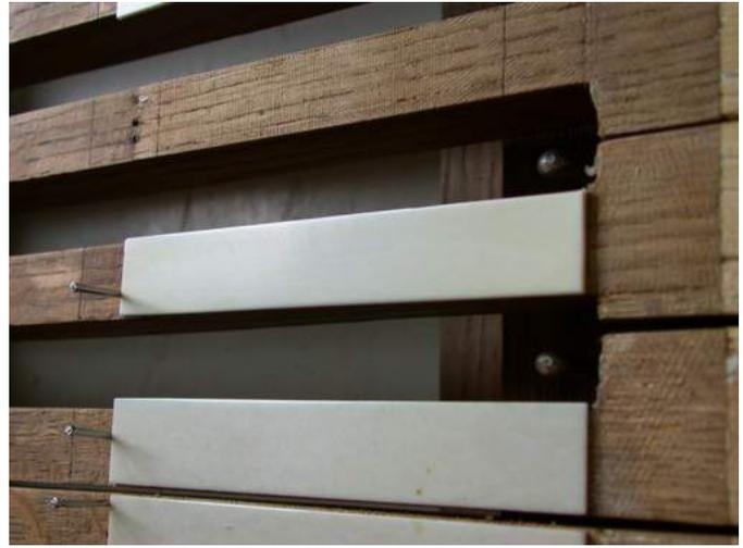
On distingue sous les placages retirés les traits de construction du clavier, servant de repères lors des opérations de placage, ainsi que les trous laissés par les pointes utilisées lors du collage.
