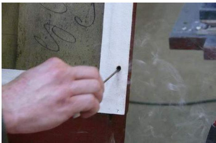
Chaque trou de vis en contact avec la peau est brûlé, comme sur les anciens, pour éviter que le cuir n'oxyde les vis acier fixant les porte-vents aux réservoirs.
