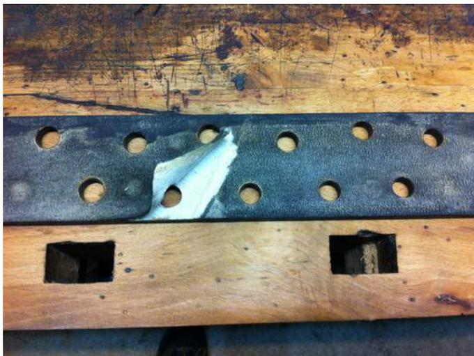
Registre du Récit : on distingue sur le haut une zone plus foncée et totalement tassée et rigide, ce qui est certainement lié à de l'eau (il semblerait qu'à un moment donné ce plan sonore ait subi un dégât des eaux). La photo montre la façon dont les peaux sont travaillées pour ne présenter aucune aspérité lors d'une passage d'une peau à l'autre : deux chanfreins inversés sur chaque côté de la bande de peau.
