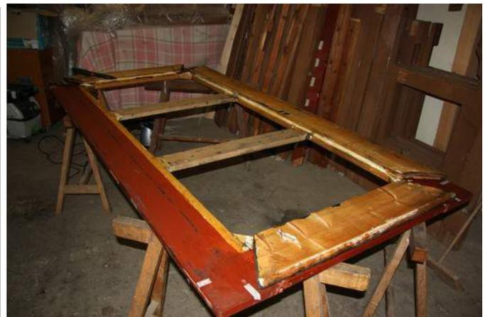
Les positions d'implantation des éclisses et notamment d'arrêt des bandes de peaux les reliant à la table sont marquées par des scotch.
