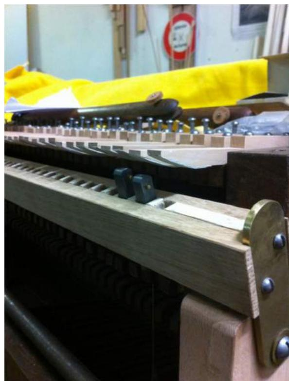
Les pilotins sont maintenus en place dans la barre par des tiges de laiton qui les empêchent de tomber en cas de démontage de la barre. En effet, ce démontage rapide (4 vis) peut s'avérer nécessaire pour reprendre le réglage du Positif (même si on y arrive en utilisant une lime ou une râpe fine).
