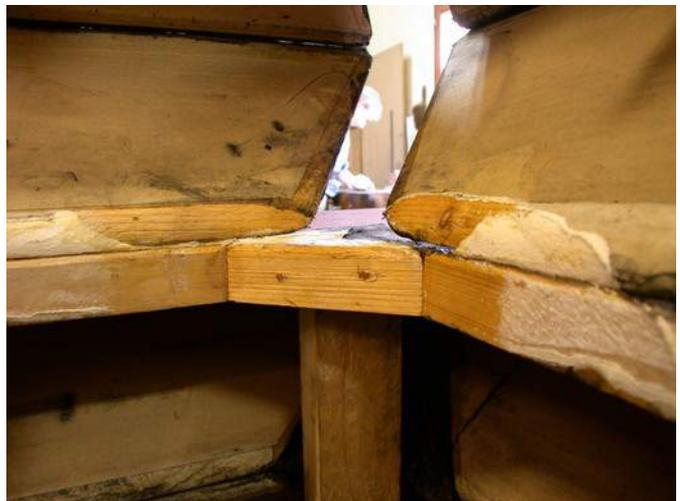
Les éclisses, une fois détachées, sont soigneusement nettoyées et éventuellement légèrement redressées à la râpe, de façon à être jointives sur le côté où elles doivent l'être. Le papier intérieur, s'il est en bon état, n'est pas systématiquement changé (il ne l'a même pas été du tout dans le cas de cet orgue). Les tables sont elles aussi débarrassées des derniers restes de cuir, des surépaisseurs de peinture, les éventuelles fentes sont bouchées si nécessaire.
