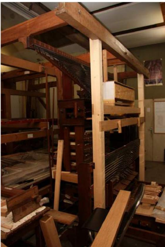
Pendant la phase de remontage des structures du soubassement à l'atelier de Macey, une « éoline » provisoire a été utilisée pour repérer les aplombs et guider la conception de sa charpente.
