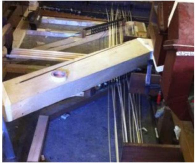
Un nouveau porte-vent destiné à relier le réservoir primaire et le réservoir forte pression GO/POS a donc été mis au point et assemblé. Ci-dessus, en cours de séchage et en haut à droite, après sa mise en place. Le tout en utilisant une entrée existante dans le réservoir forte pression et en évitant la mécanique note et jeux du Récit, d'où sa forme particulière.
