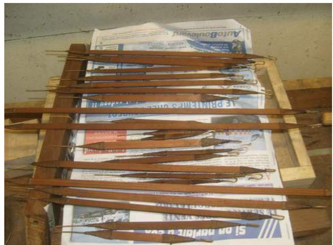
Les vergettes ont été nettoyées à l'éponge bouillante serrée puis les fils et laitons vérifiés et remplacés à l'identique quand nécessaire.
