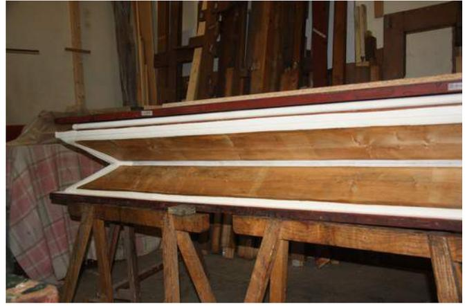
Le réservoir primaire avant collage du papier sur les éclisses : là aussi, le travail sur fait avec des cales à l'intérieur pour permettre une ouverture maximale des plis et un collage sur toute la surface des éclisses.
