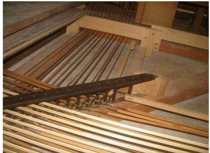
Après remontage des vergettes et adjonction des relais d'appels d'anches. Ces derniers ont été faits sur le même principe que les relais pour les notes, mais avec des barres d'acier de dimensions supérieures (ici avec les tirants en chêne, sur la droite du relais).
