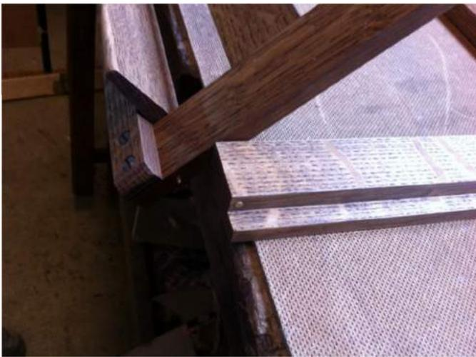
Il est pliant et escamotable, accroché à l'intérieur du couvercle. Il a été nécessaire de le rendre le moins épais possible pour ne pas toucher les claviers. Il ne contient donc pas d'étage se dépliant vers le haut, ce n'était pas possible.
