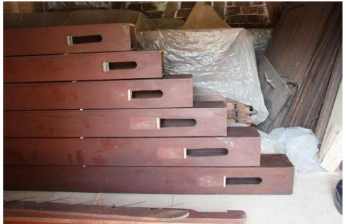
Les systèmes d'accord du Principal Bass de 16' a été harmonisé par série : ici, les plaques réglables en hauteur ont été remplacées par des bandes de plombs roulées, comme à l'origine (traces de perçages retrouvées)
