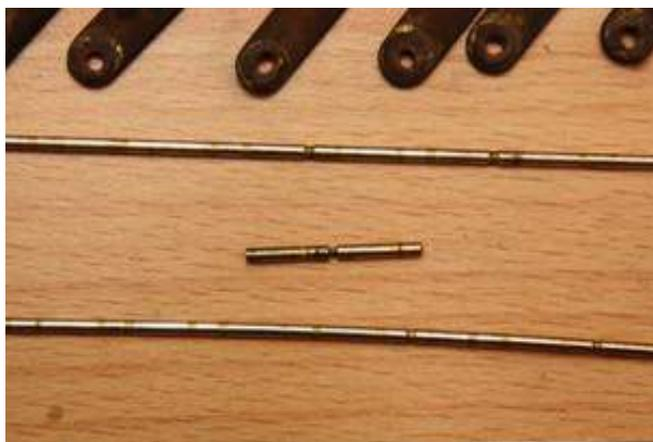
L'axe commun des barres d'équerre de sortie du clavier de GO était de loin le plus utilisé, brisé par endroit (d'où des réparations de fortunes) ou ne tenant plus que sur 3 dixièmes de mm, comme sur la photo ci-dessus. Il a bien entendu été remplacé par un neuf. Ceux de Positif et Récit, bien moins usés, ont simplement été décalés pour que l'usure ne se poursuive pas au même endroit.
