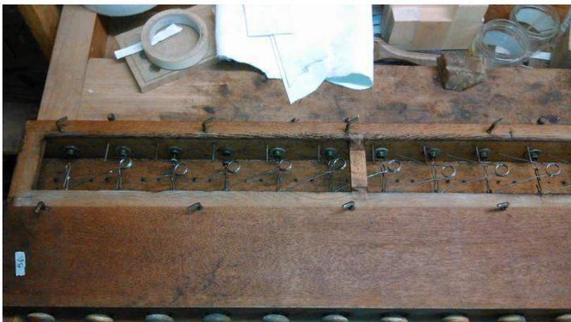
Les éléments mécaniques de chaque tiroir ont été démontés, nettoyés, puis remontés. Les esses et les ressorts posés par Mutin à l'intérieur ds laye, ont tous été remis. On peut voir sur les photos de droite la comparaison entre avant et après le nettoyage des layes.
