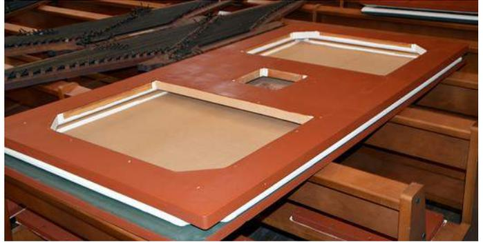
Mise en peinture des réservoirs avant leur mise en place dans l'instrument. La vue est ici sans les couvercles (c'est un des réservoirs du Récit) qui permettent un accès à l'intérieur du réservoir. Ils ont également été décapés et remis en peinture.
