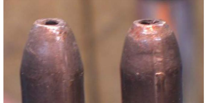
Certains fraisages sont d'origine, intacts depuis leur fabrication dans les ateliers de Cavallé-Coll. En effet, la coupe au bout du pied est nette, aucun coup visant à réduire l'ouverture n'est visible (à gauche ; à droite par contre, on voit nettement l'intervention d'un harmoniste). Ces paramètres « d'origine » ont été très précieux au moment de l'harmonisation.
