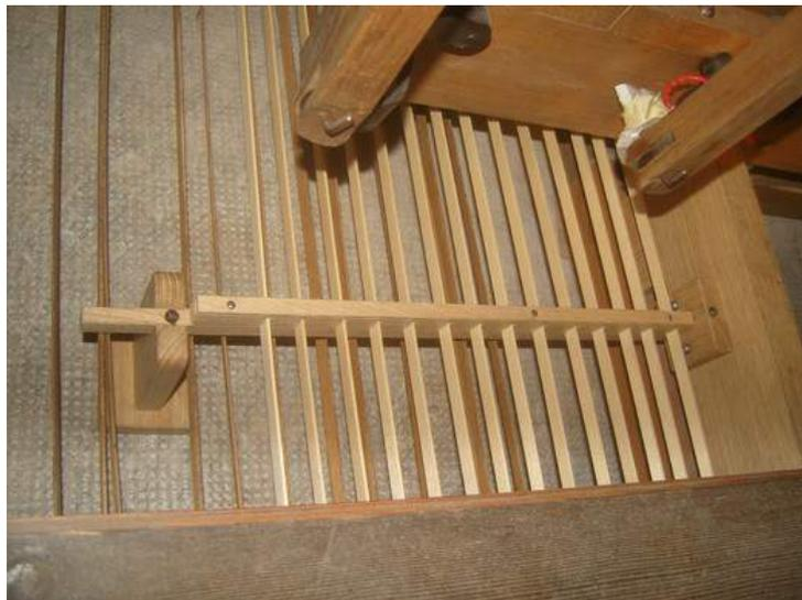
Les vergettes de pédales ont été guidées par des guides fabriqués en copie de facture de ceux existant. En effet, il fallait limiter les frottements, encore accentués par rapport à avant du fait de l'écartement des sommiers de pédale et de l'ajout de ces nouveaux relais mécaniques.
