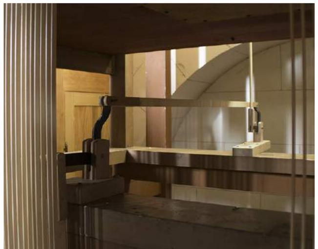
Le trajet de commande du trémolo de Récit a pu être reconstitué grâce aux trous de vis subsistant. Les relais mécaniques, ici les équerres, ont été faits en utilisant au maximum les pièces anciennes laissées par Mutin (pour les parties de la mécanique jeu du Récit qui n'ont pas été remises). La commande a été faite en copie de facture de la commande de trémolo Positif (grosses vergettes).
