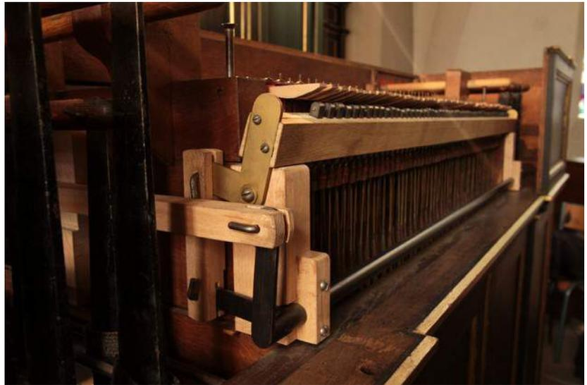
Le dispositif une fois en place. Le rouleau a été fabriqué lui aussi en copie de facture et le trajet mécanique a été reconstitué par rapport aux traces subsistant dans le meuble de console.
