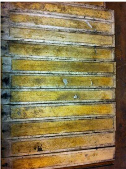
Soupapes dont la baudruche est abîmée. Aucun changement n'est systématique : seules les trous importants sont gênants. Parfois la baudruche est légèrement fendue là où frottent les guides. Ce n'est pas forcément gênant.
