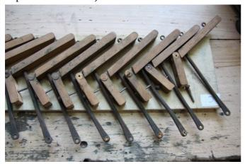
Les contre-touches du pédalier étaient par contre en très mauvais état et causaient de nombreuses pannes. Soumises à de fortes pression du fait de la mécanique longue et complexe qu'il y a derrière (6 soupapes et plus de 15 mètres de vergettes à tirer pour certaines d'entre elles...), les axes des crapaudines étaient à 80 % hors d'usage.
