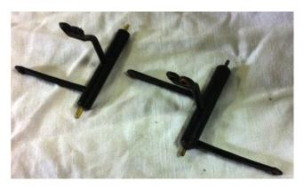
Comparaison entre un relais d'origine (à droite) et un relais en copie de facture, qui ne nécessite de que deux bras puisque seules trois vergettes lui sont reliées (voir schéma mécanique).
