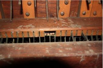
Le châssis a été complètement démonté car les barres d'équerres du bas, pour la mécanique note, était en partie encastrées dans les montants (notamment celle du GO, qui était de loin la plus abîmée). Ci-dessus à droite, un exemple de réparation de fortune pour maintenir jouable l'instrument avant restauration.
