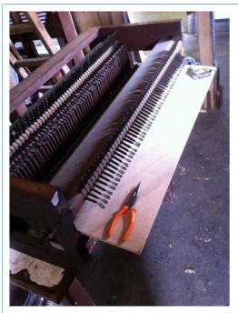
Le bloc mécanique situé au-dessus de la machine et contenant les systèmes d'accouplement a été entièrement démonté, nettoyé et reréglé. Les oeillets ont du être partiellement refait (surtout ceux situés à l'extérieur de la machine et reliés au Récit).
