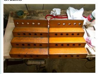
Les gradins des tirants de jeu ont été restauré en utilisant un rénovateur spécialement conçu pour les vernis au tampon. A part un encrassement certain, il n'y avait pas de manque ou de trou dans ce vernis particulièrement fragile. La photo ci-contre montre le gradin de droite après traitement et nettoyage. Il est à noter que le vernis au tampon est extrêmement fragile. Il nous est arrivé de trouver des trous dans des gradins de cette époque uniquement parce que des scotch (avec des puméros
