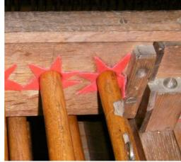
Les cravates en casimir, très usées, ont été déposées pour être remplacées. Ce n'étaient pas les cravates d'origine (voir photo de gauche) car les anciennes avaient un retour de collage à l'arrière des gratins en chêne (en étoile). Ces traces étaient encore visibles (photo de droite, tirant le plus à droite).
