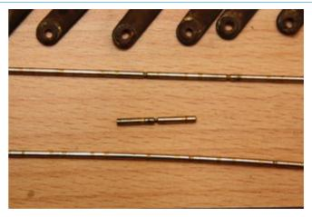
L'axe commun des barres d'équerre de sortie du clavier de GO était de loin le plus usé, brisé par endroit (d'où des réparations de fortunes) ou ne tenant plus que sur 3 dixièmes de mm, comme sur la photo ci-dessus. Il a bien entendu été remplacé par un neuf. Ceux de Positif et Récit, bien moins usés, ont simplement été décalés pour que l'usure ne se poursuive pas au même endroit.
