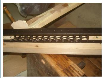
Les relais après montage sur les traverses de la nouvelle semelle, reliant la semelle du GO/POS à celle des sommiers de Pédale. Ci-dessous, montage des vergettes sur le relais. Toutes ont été posées en atelier, une à une.
