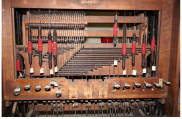
Vue intérieure du bas de la console au démontage. L'orage, à gauche, est toujours bouché, ainsi que le trémolo Récit et l'accouplement III/II.
