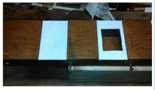
Les montants de la machine sont des porte-vent qui alimentent chacun des tiroirs. Les jonctions d'étanchéité ont été repeaussées car elles avaient souffert de manipulation visant à sortir les tiroirs sans démonter la machine complète (c'est en effet le seul moyen d'accéder aux layes des tiroirs).
