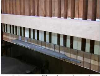
Les ivoires sont collés en laissant les touches en place dans le châssis de façon à pouvoir vérifier les alignements. Ceux-ci sont corrigés à la lime après séchage.
