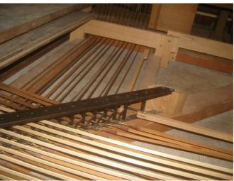
Après remontage des vergettes et adjonction des relais d'appels d'anches. Ces derniers ont été faits sur le même principe que les relais pour les notes, mais avec des barres d'acier de dimensions supérieures (ici avec les tirants en chêne, sur la droite du relais).
