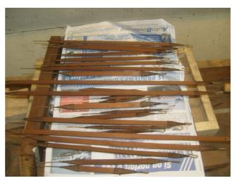
Les vergettes ont été nettoyées à l'éponge bouillante serrée puis les fils et laitons vérifiés et remplacés à l'identique quand nécessaire.
