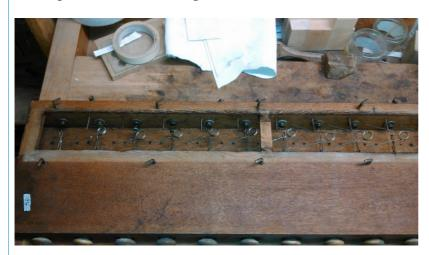
Les éléments mécaniques de chaque tiroir ont été démontés, nettoyés, puis remontés. Les esses et les ressorts posés par Mutin à l'intérieur ds laye, ont tous été remis. On peut voir sur les photos de droite la comparaison entre avant et après le nettoyage des layes.
