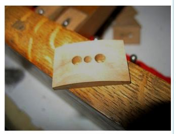
Plaquette en cours de fabrication. Elles sont faites en bois dur (alisier) pour résister le plus longtemps possible à l'usure.
