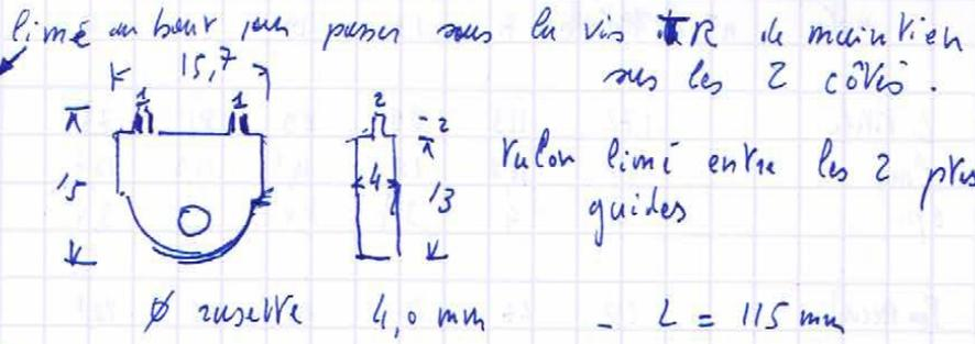
Limé au banc pour passer sous la vis de maintien sur les 2 côtés.
