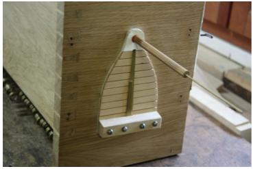
Le mécanisme d'expression a donc été reconstitué d'après les traces relevées à Luçon. On y distinguait des trous de vis correspondant à la charnière mis au point sur la photo ci-contre.
