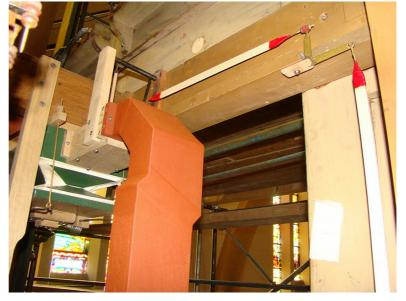
On peut voir que le rouleau commandant le coupe vent a deux supports dont un était toujours fixé à la charpente au moment du démontage. Il a suffit de reconstituer l'autre accroché au porte-vent contenant la soupape de coupe vent.
