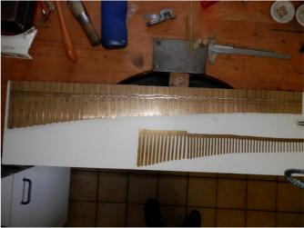
Usinage des anches et préparation des languettes. Toutes les dimensions indiquées ont été reprises de celles relevées à Luçon (voir pages précédentes avec les plans et le tableau des tailles).
