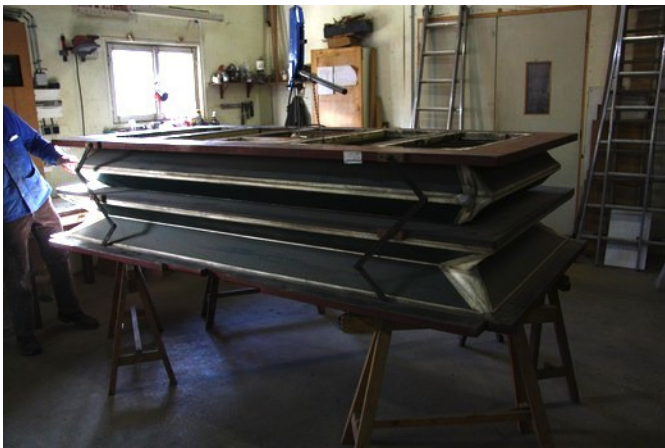
Le réservoir est suspendu pour pouvoir travailler à l'intérieur dans de bonnes conditions.
