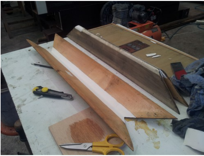
Assemblage des éclisses après nettoyage, décapage et dressage.
