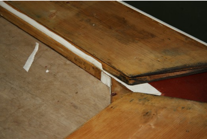
Après avoir été assemblées et dressées sur chants, les éclisses sont liées à la table.
