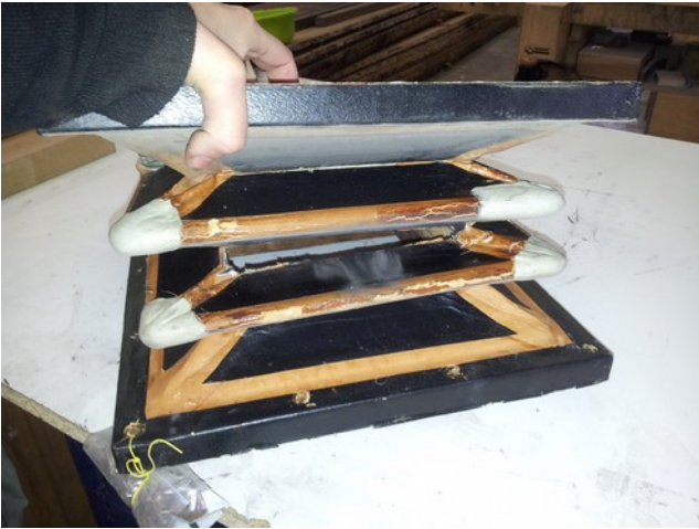
Gosier Récit avant nettoyage et restauration. Les angles sont très abîmés, ce qui est logique vu l'utilisation intense de ces pièces.
