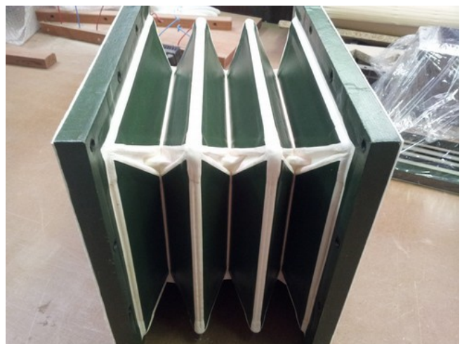
Gosier terminé, après pose des papiers extérieurs, identiques à ceux utilisés pour les réservoirs.
