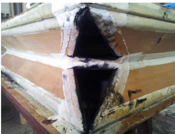
Même réservoir après nettoyage intérieur et décapage des éclisses.
