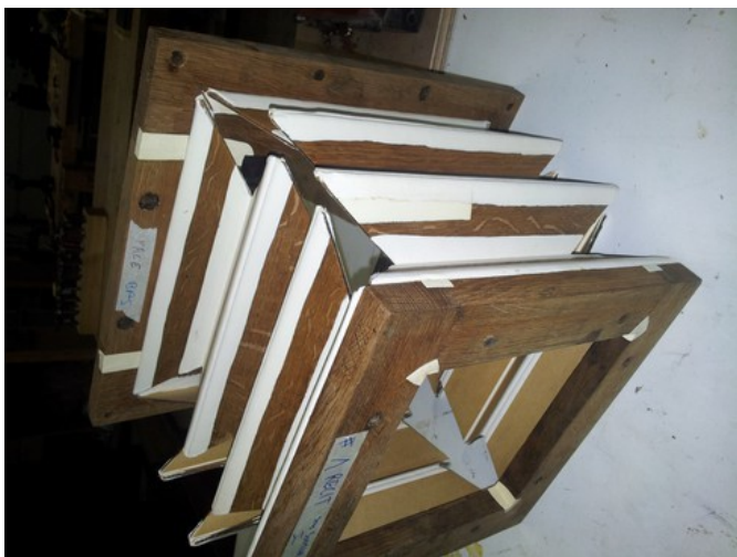
Gosier en cours d'assemblage (éclisses et tables)
