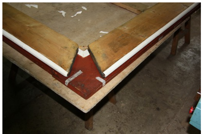
Les éclisses sont placées par rapport aux repères laissés sur la table au démontage.
