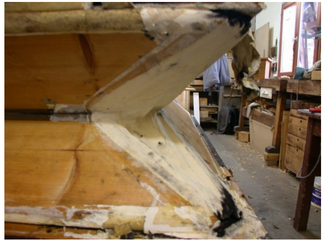
Les bandes mises en dernier le long des éclisses viennent aussi recouvrir les aines.
