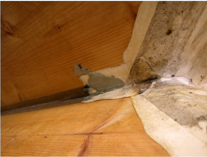
De petites bandes très chanfreinées renforcent l'étanchéité des aines à la pliure des éclisses.
