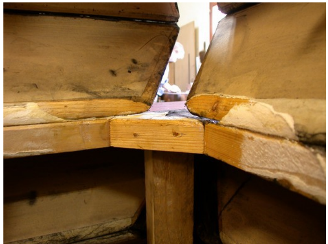
Les largeurs des bandes de peau utilisées, leur emplacement, les zones et largeurs de recouvrement des différentes pièces de cuir, l'ordre dans lequel les différentes parties sont assemblées, tout cela est noté au démontage pour garantir un repeaussage en copie de facture.
