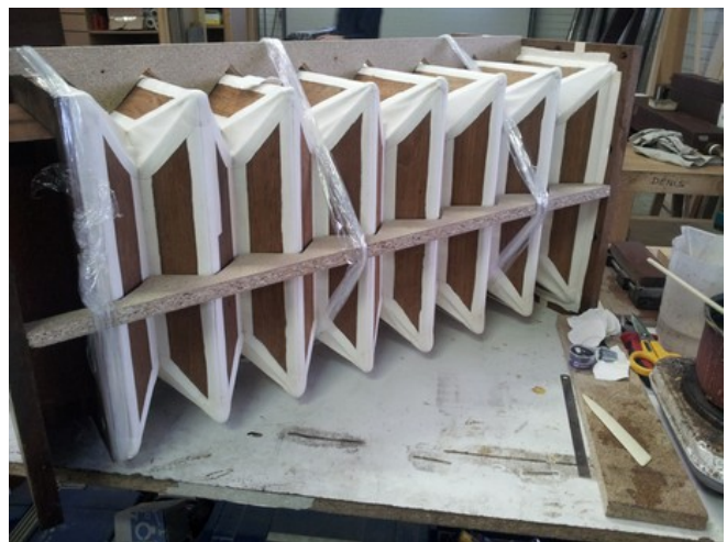
Montage pour le collage des aines sur un gosier : il est fondamental de le maintenir en position 3/4 ouverte pendant cette étape pour avoir accès au creux des aines.
