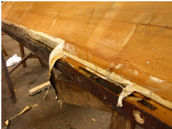
On voit clairement deux bandes l'une sur l'autre pour relier l'éclisse à la table, par l'intérieur.
