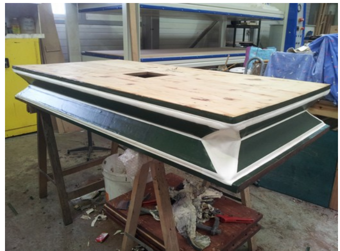
Réservoir de Récit après la pose des papiers et avant mise en peinture.
