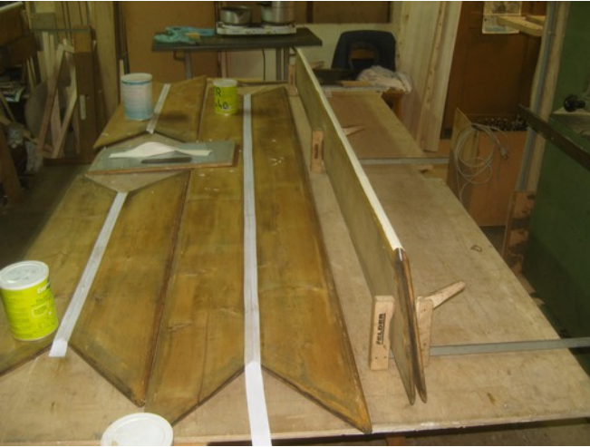
Les éclisses sont assemblées, à plat, par du sergé pour la partie rentrante du plis.
