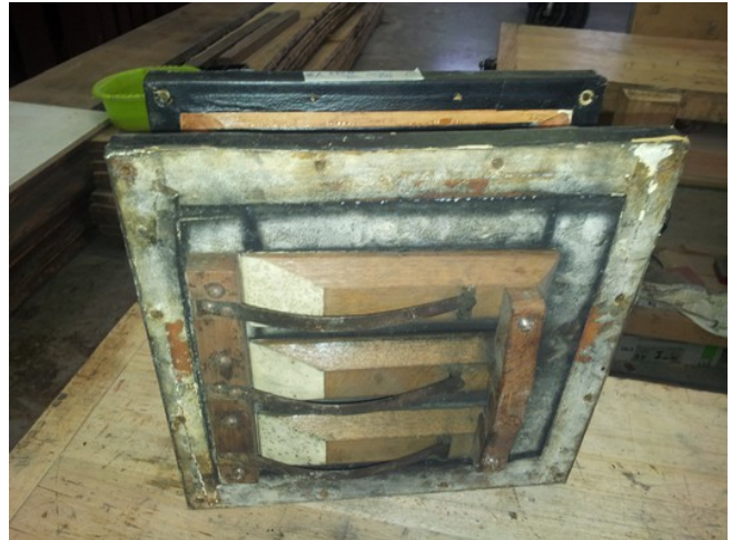
Les soupapes servant à réguler le vent entre les deux étages de la soufflerie du Récit (deux fois deux réservoirs les uns au-dessus des autres)
