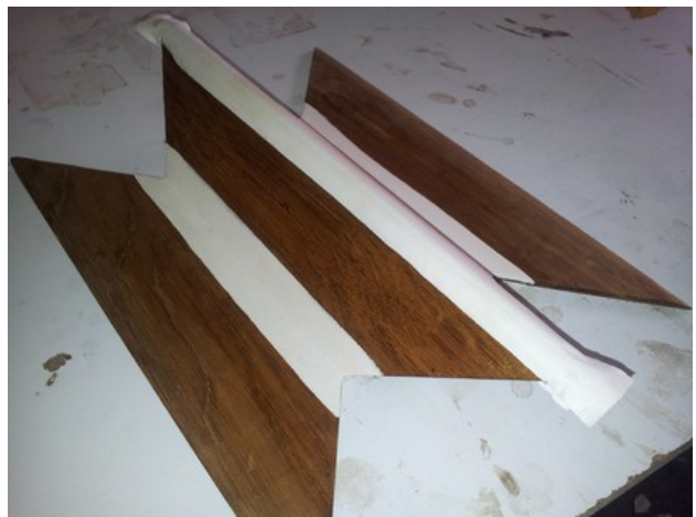
Eclisses en cours d'assemblage après leurs nettoyage et décapage complet.
