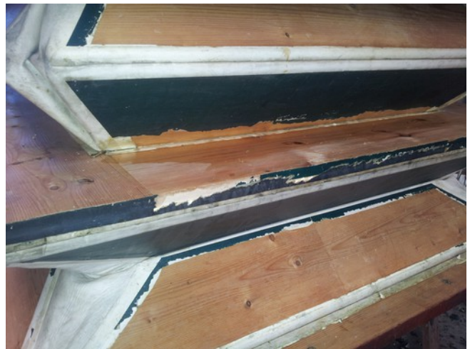
Réservoir Basse Pression GO/POS en cours de décapage des éclisses. Il a été entièrement remis en peaux, comme les autres réservoirs du Récit présentés ici.
