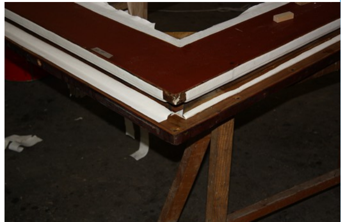
Des bandes de peau sont ajoutées par l'extérieur pour lier les éclisses à la table.
