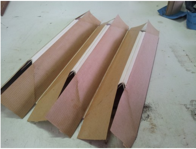
Eclisses repapiétées après avoir été assemblées par des bandes de peau.
