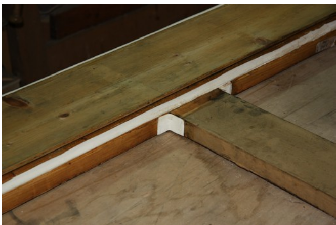
Des petites bandes de peau sont remises aux angles des assemblages des tables.
