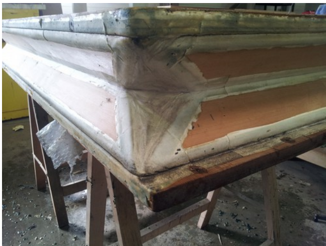
Même réservoir après nettoyage intérieur et décapage des éclisses.
