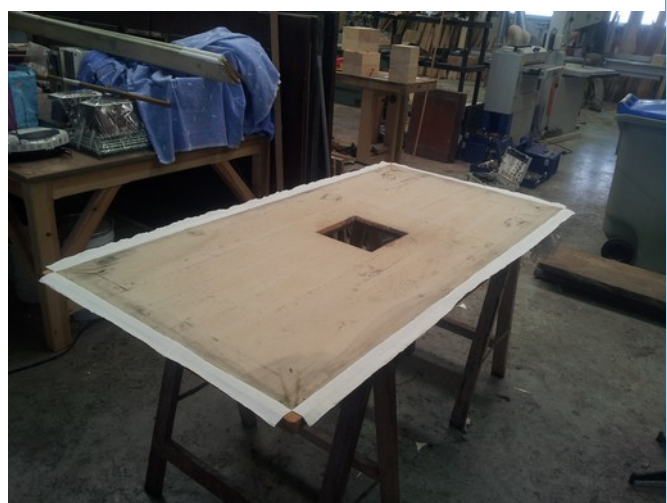
Même réservoir après nettoyage intérieur et décapage des éclisses.
